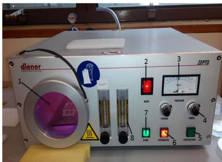
Figura 5.20 Equipamento utilizado para gerar plasma de O_2 . O equipamento é constituído por: 1) câmara de reação em aço inoxidável; 2) Botão de ligar/desligar o equipamento; 3) Indicador de pressão; 4) Temporizador; 5) Botão de ventilação; 6) Botão de ligar/desligar o gerador de plasma; 7) Botão ligar/desligar a bomba de vácuo e 8) Botão de abrir/fechar válvula do gás.
