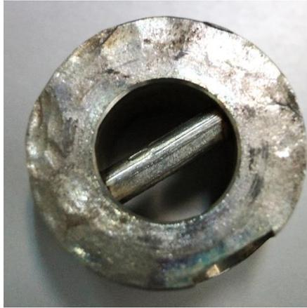
Figura 5.3 – Adaptador para o bico injetor de 50 g/s.
