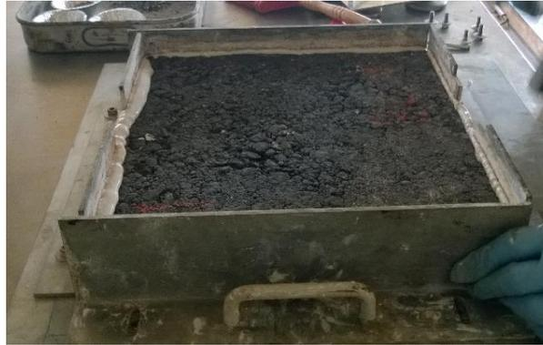
Figura 3.23 – Colocação da lajeta de mistura betuminosa no molde para o ensaio de pista.
