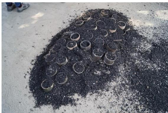
Figura 6.30 – Aquecimento dos moldes onde foram compactados os provetes recolhidos na central para os ensaios de sensibilidade à água.
