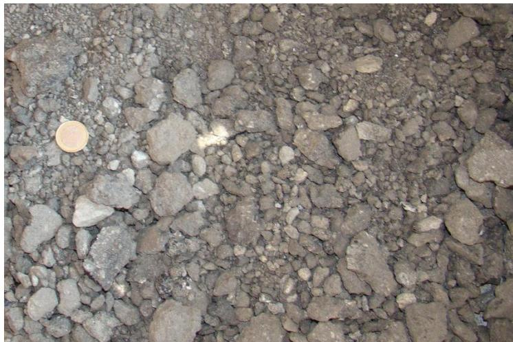
Figura 2.4 – Aspeto do material após fresagem.
