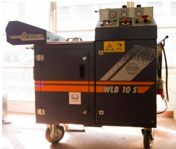
Figura 3.16 – Equipamento laboratorial para a produção de betume-espuma.
