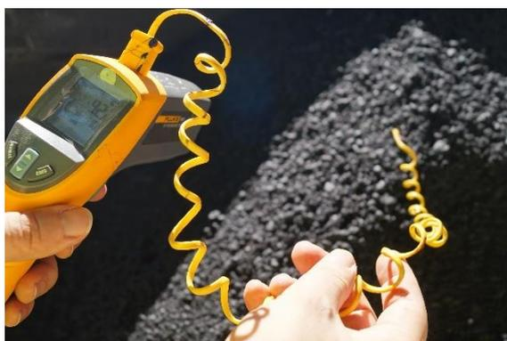
Figura 6.31 – Controlo da temperatura da mistura.
