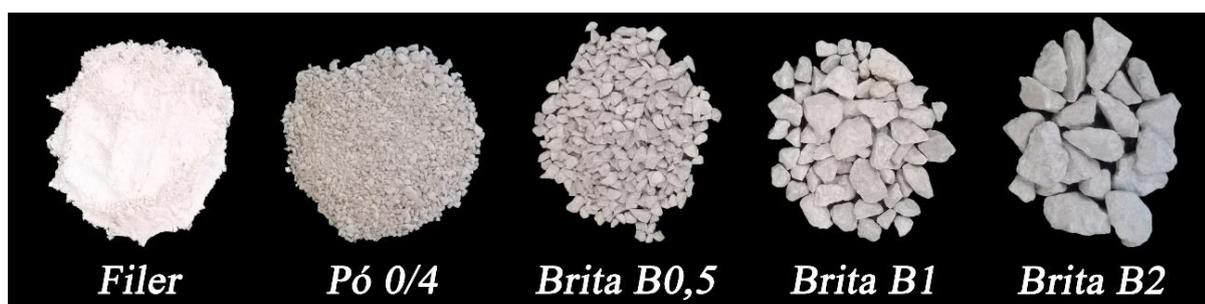
Figura 5.38 – Aspeto das diferentes dimensões dos agregados calcários utilizados.
