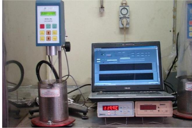
Figura 3.8 – Equipamento de ensaio para determinação da viscosidade dinâmica.
