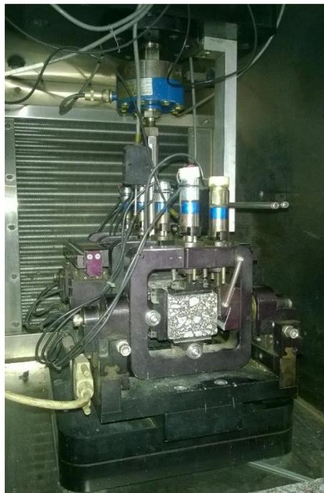
Figura 3.24 – Equipamento utilizado para o ensaio de flexão em quatro pontos.
