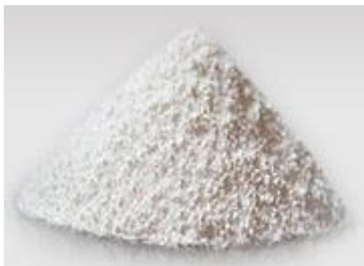
Figura 2.12 – Aspeto do aditivo Aspha-min® (Aspha-min GmbH (2009)).
