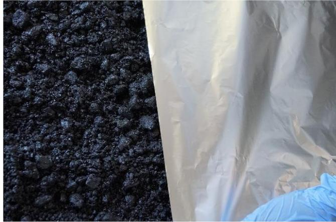
Figura 5.44 – Condicionamento da mistura em tabuleiro coberto com folha de alumínio.
