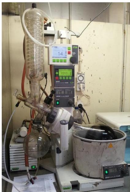
Figura 3.5 – Evaporador rotativo utilizado para a separação entre o solvente e o betume.
