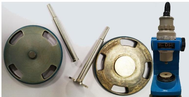
Figura 3.9 – Equipamento e pratos do ensaio reológico realizado no DSR.
