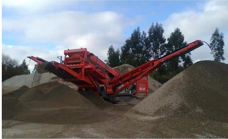
Figura 2.5 – Classificador industrial usado para a separação do material fresado (Palha et al., 2014).
