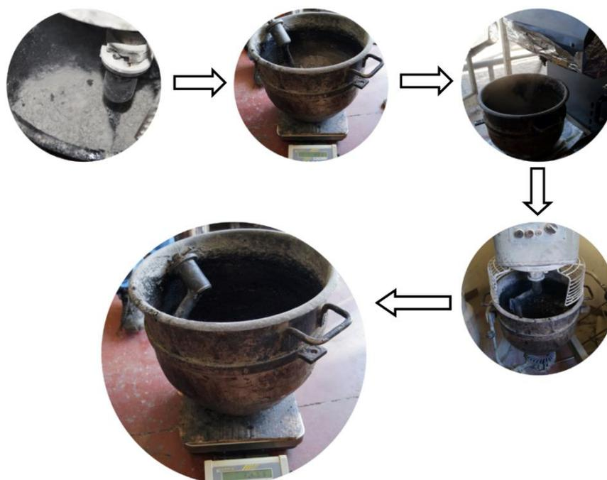
Figura 5.47 – Esquemática do sistema de pesagem adotada nas misturas com betume-espuma.
