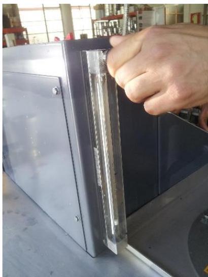
Figura 3.18 – Ajuste da quantidade de água a ser usada para a produção de betume-espuma.
