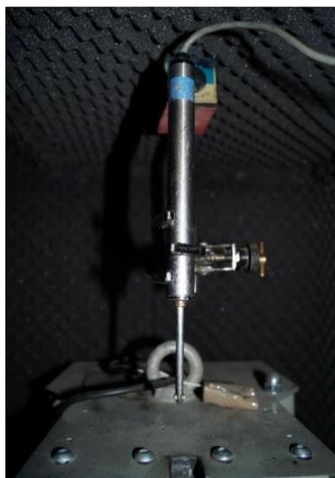
Figura 3.12 – LVDT utilizado para medir o adensamento da mistura no ensaio de compactabilidade.
