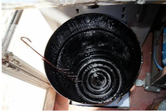
Figura 3.19 – Balde e escala associados ao equipamento Wirtgen WLB 10 S para medição das características de expansibilidade.
