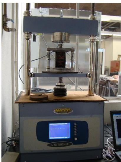
Figura 3.22 – Equipamento para realização de ensaios de tração indireta.
