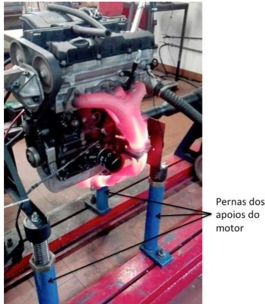
**Figura 48 – Motor instalado na bancada de potência.**
