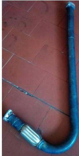
**Figura 37 – Tubo de ligação do circuito de escape com elemento flexível de absorção de vibrações.**
