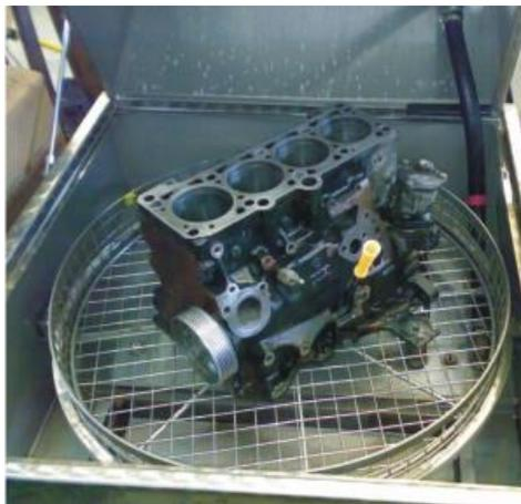
**Figura 6 – Máquina desengordurante de movimento rotativo [7].**
