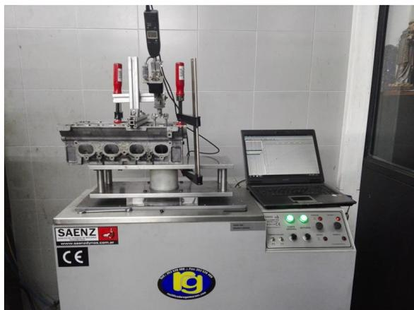
**Figura 26 – Fluxômetro utilizado nos testes da marca SAENZ, modelo J-600.**
