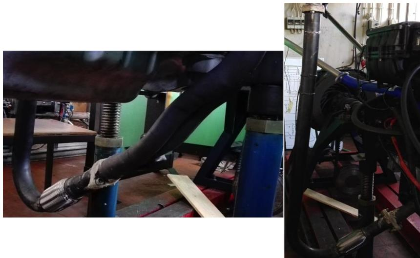
**Figura 38 – Tubo de ligação do circuito de escape instalado.**
