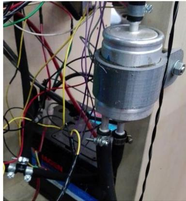
**Figura 34 – Circuito de combustível – saída do depósito (em cima à esquerda); ligação em “T” para circuito de retorno (em cima à direita); e filtro de combustível com saída para o motor (em baixo).**
