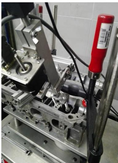
**Figura 47 – Atuador de válvulas.**
