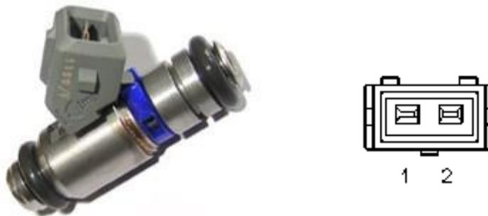
**Figura 56 – Injetor *IWP006* (esquerda) e conector (direita); 1 – Ground; 2 – 12 V.**
