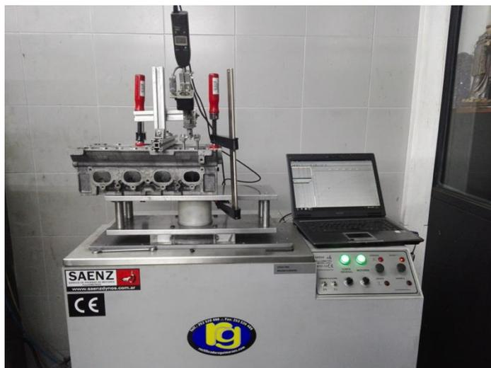
**Figura 77 – Culassa montada no fluxômetro.**
