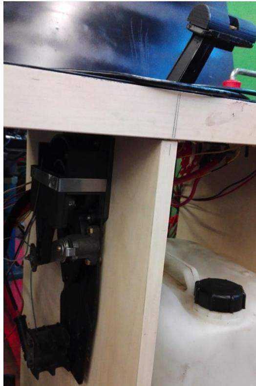
**Figura 33 – Acelerador de controlo da abertura da válvula borboleta.**
