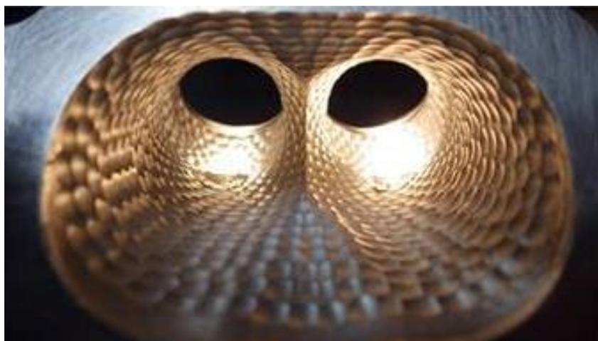
**Figura 19 – Conduta alargada com *Dimpling* de motor TU5JP4 (grupo PSA).**
