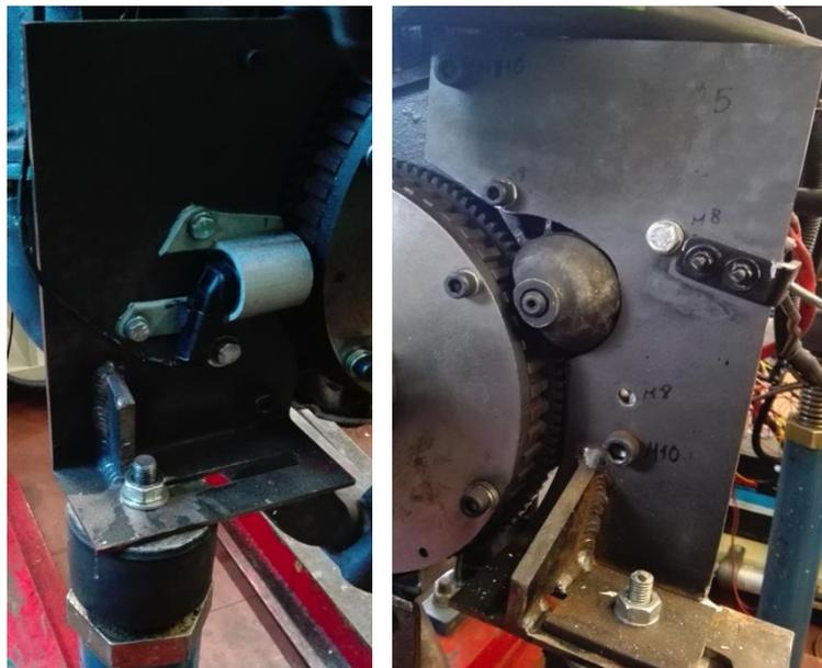
**Figura 29 – Apoio dianteiro (ligação ao freio) esquerdo (esquerda) e direito (direita) do motor.**
