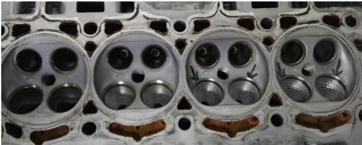
**Figura 74 – Parte inferior da culassa com diferentes níveis de alteração. Da esquerda para a direita – CO/SO; CA/SO; CA/SC; e CA/SC+D.**
