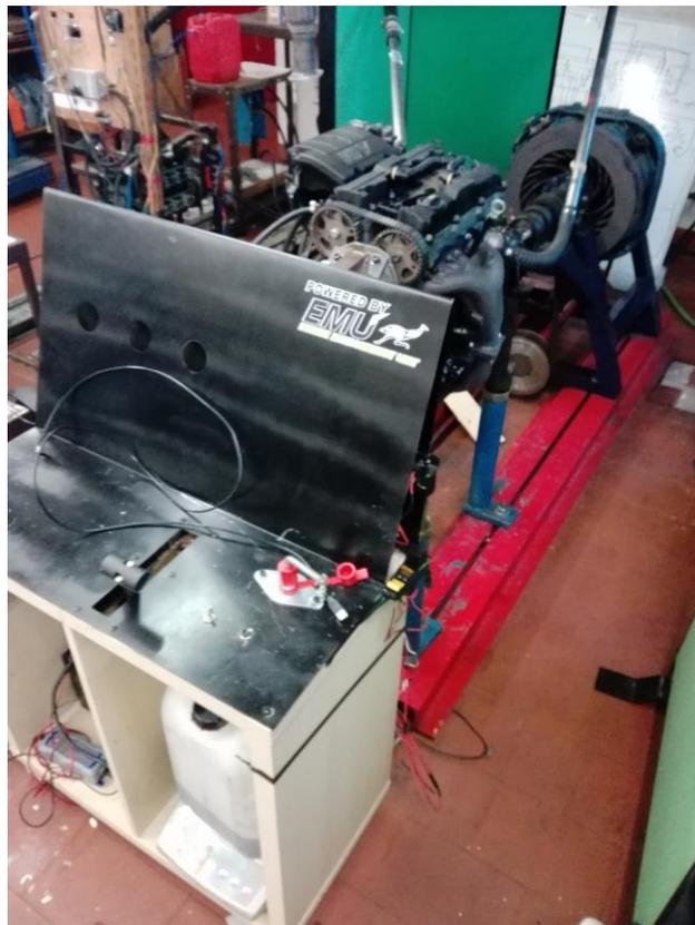
**Figura 28 – Bancada de potência (freio, motor e bancada de instrumentação).**
