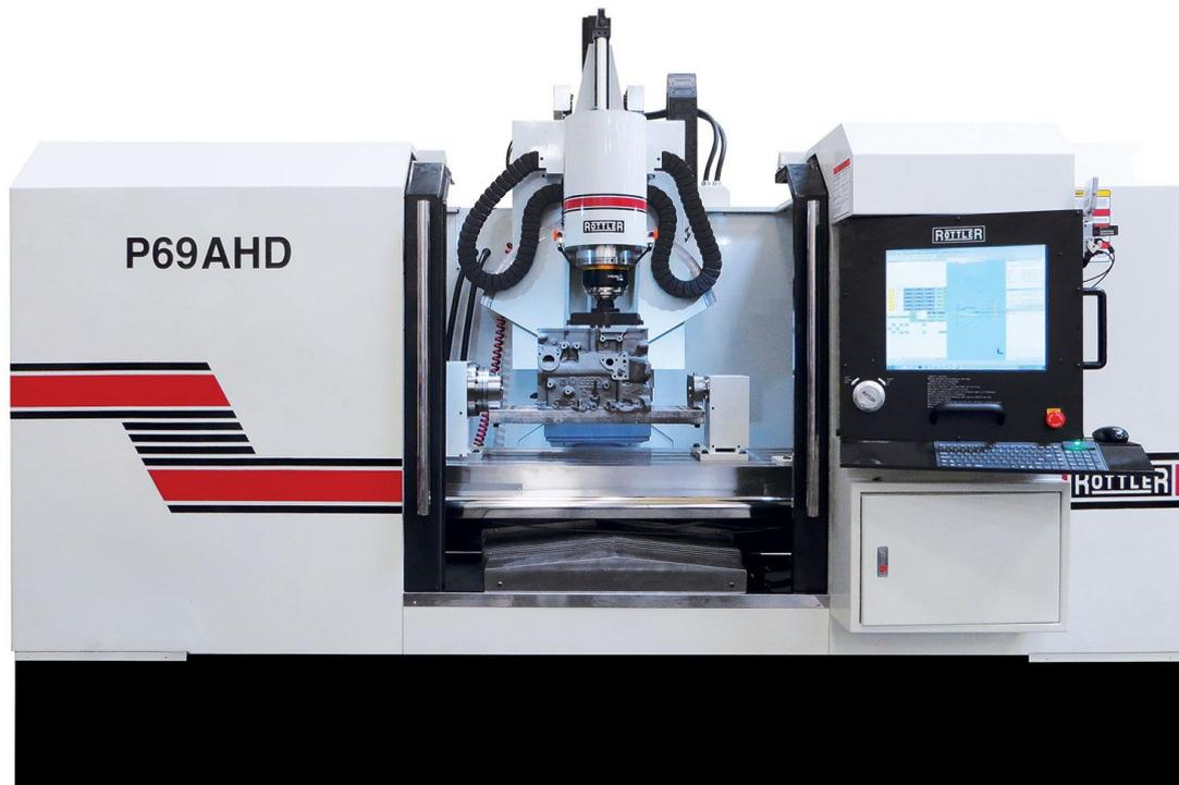
Figura 22 – Fresadora CNC multi-ferramentas da marca *Rottler* modelo P69AHD – existente na Rectificadora [26].
