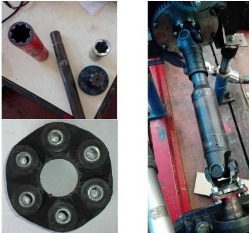
**Figura 31 – Transmissão com veio dentado e borracha flexível descartada (esquerda) e transmissão tipo *cardan* (direita).**
