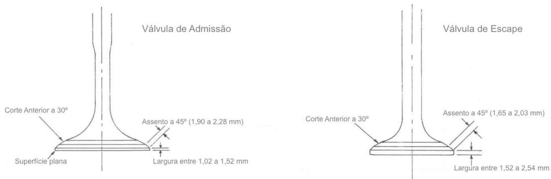
**Figura 14 – Representação das válvulas de admissão (esquerda) e escape (direita) e respectivos ângulos e distâncias referentes ao seu perfil [17].**
