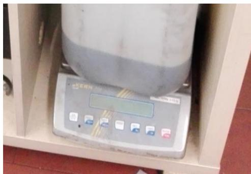
**Figura 35 – Balança digital usada na medição da massa de combustível.**
