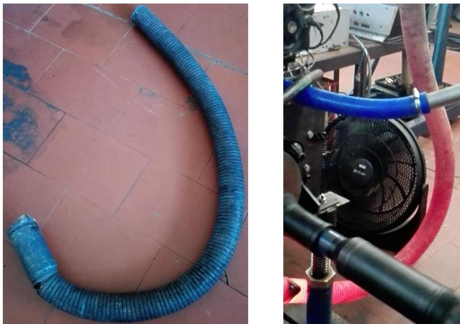
**Figura 36 – Manga flexível de ligação do circuito de escape (esquerda); Em utilização (direita).**
