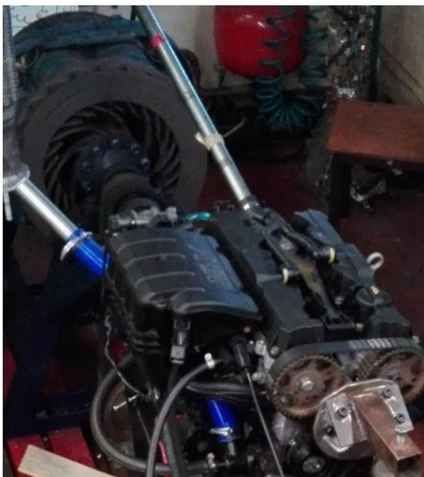
**Figura 24 – Freio dinamométrico (Telma AD61-55) utilizado no projeto com motor acoplado.**
