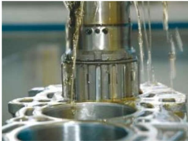
**Figura 9 – Ferramenta de polimento, rotativa e própria para cilindro de motores [10].**
