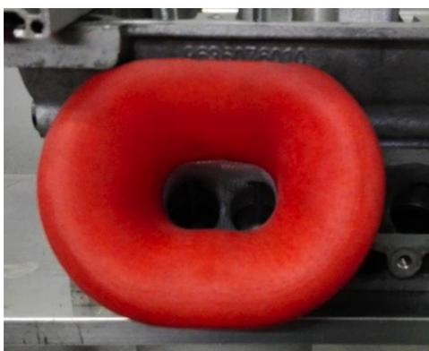
**Figura 84 – *Bellmouth* (bocal) obtido por impressão 3D.**
