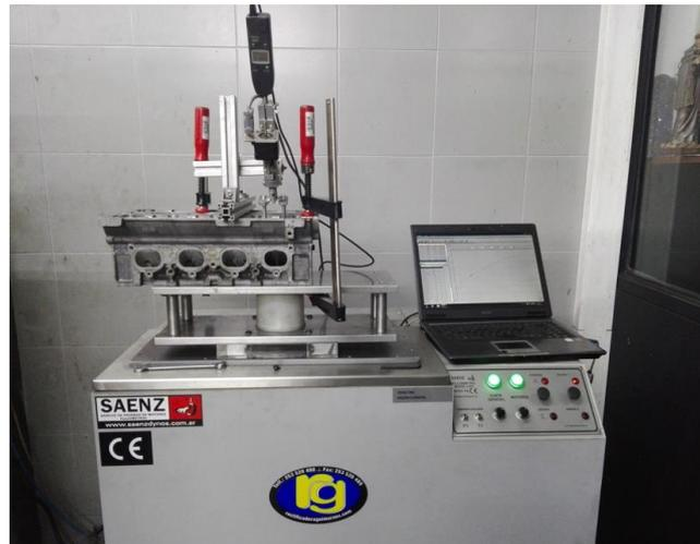
**Figura 46 - Culassa montada no dispositivo pronta a ser testada.**
