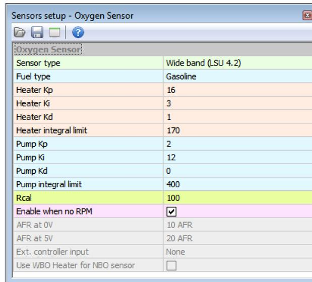
**Figura 66 – Janela de definição dos parâmetros da sonda *lambda*.**
