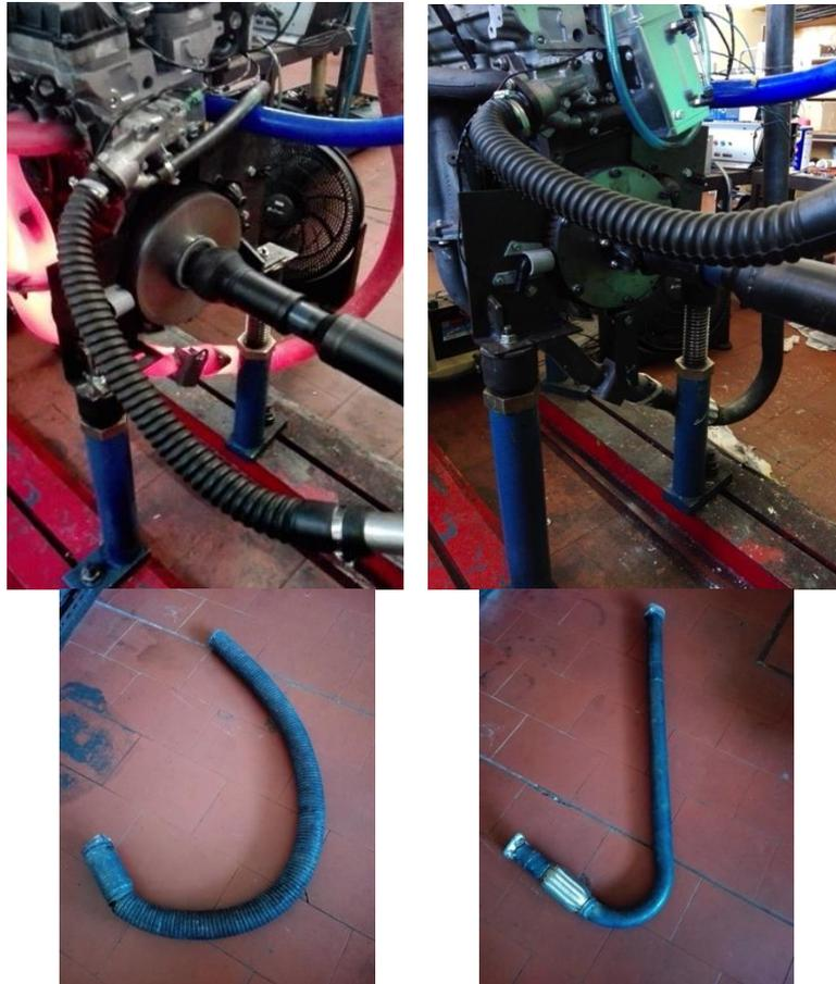
**Figura 98 – Ligação da linha de escape. À esquerda – manga flexível; à direita – tubo rígido.**
