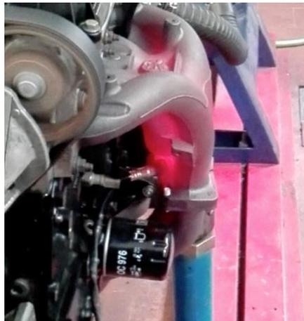
**Figura 65 – Sonda *Lambda* acoplada no coletor de escape.**
