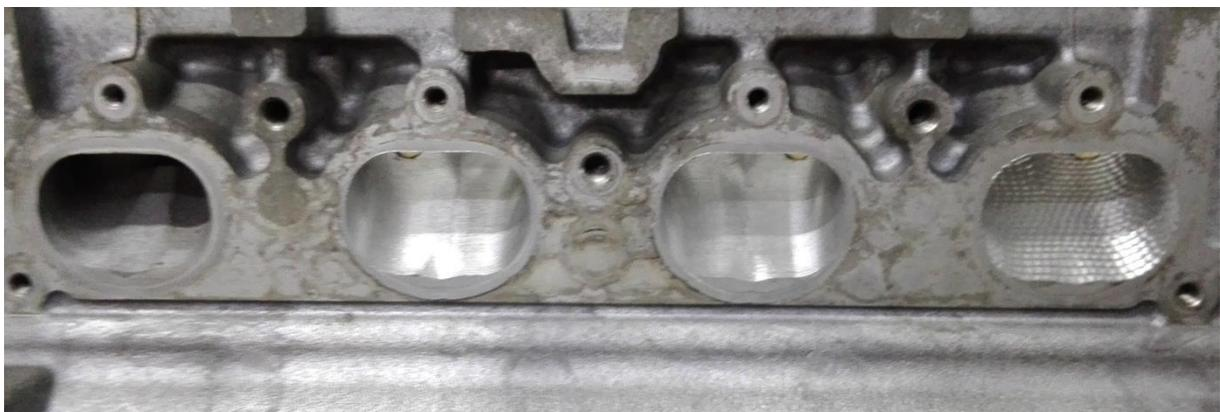
**Figura 75 – Conduas da culassa com diferentes níveis de alteração. Da esquerda para a direita – CO/SO; CA/SO; CA/SC; e CA/SC+D.**
