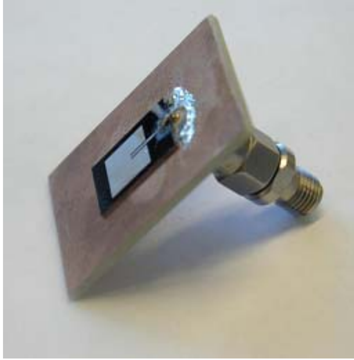
Fig. 5- Micro-antena a operar em 5.7 GHz (área de 8 mm 2 ).
