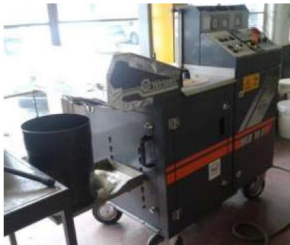
Figura 3.6 – Equipamento laboratorial Wirtgen WLB 10 S utilizado para produção de betume-espuma
