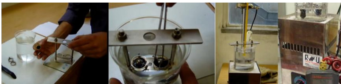
Figura 3.4 – Fases do ensaio anel e bola para determinar o ponto de amolecimento do betume
