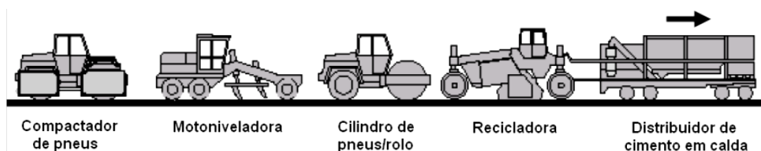
Figura 2.5 – Exemplo de reciclagem in situ com cimento em calda (Baptista, 2006)
