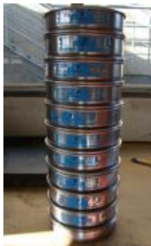
Figura 3.15 – Peneiros utilizados para determinar a granulometria do material fresado
