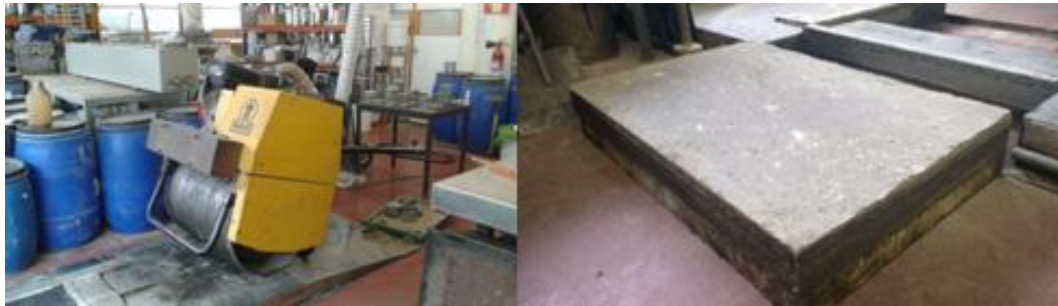
Figura 3.22 – Compactação das lajes e aspecto final das lajes compactadas
