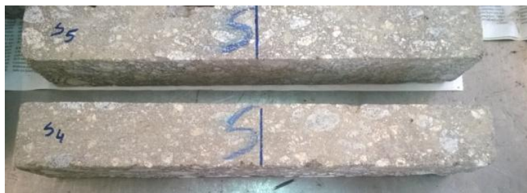
Figura 4.16 – Aspeto homogéneo das vigas com 100% material granular
