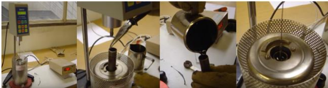
Figura 3.5 – Fases do ensaio de viscosidade dinâmica
