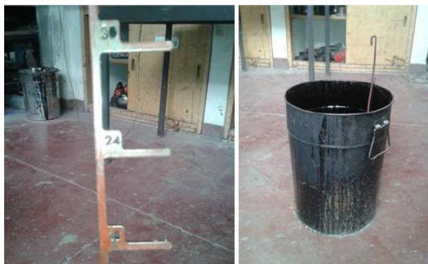
Figura 3.7 – Escala e balde utilizado para a medição do tempo de meia vida e da taxa e expansão do betume-espuma
