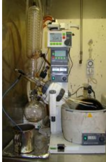
Figura 3.18 – Evaporador rotativo utilizado na 3ª fase de recuperação do betume
