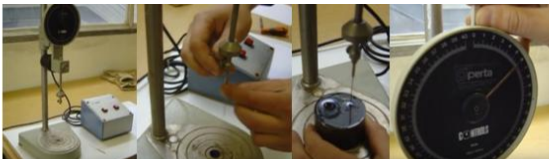
Figura 3.3 – Fases do ensaio de penetração do betume a 25 °C
