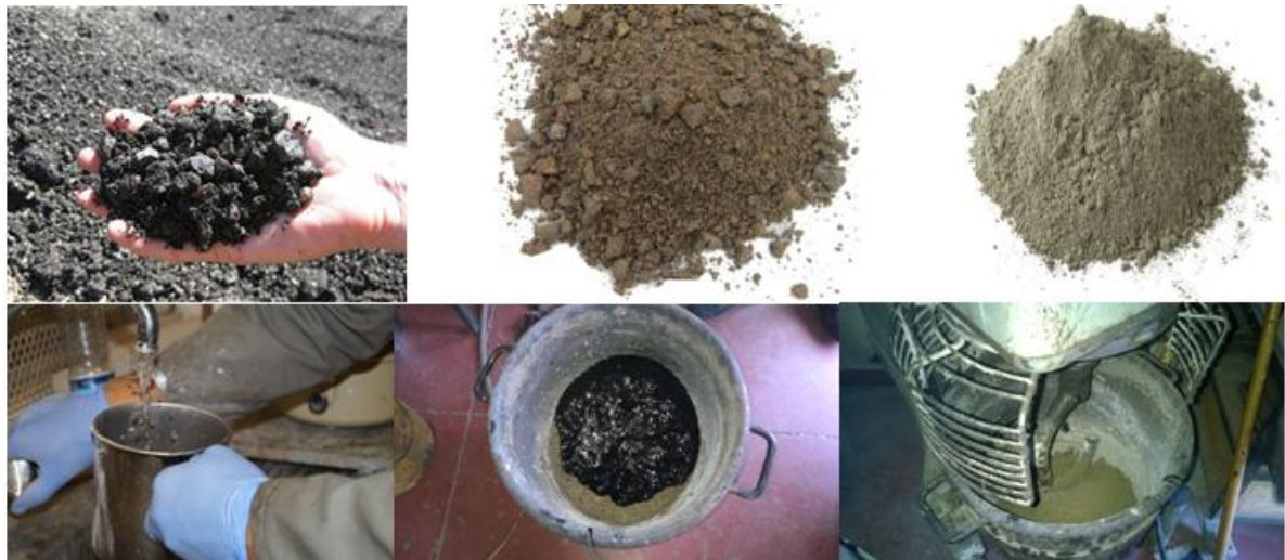
Figura 3.20 – Produção da mistura reciclada com 50% material granular e 50% material fresado
