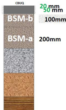
Figura 2.18 – Solução adotada para recuperação da rodovia Ayrton Senna (Cipollina, 2015)
