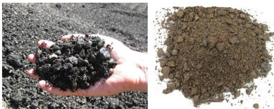
Figura 3.1 – Material fresado (esquerda) e tout venant (direita) utilizados no trabalho
