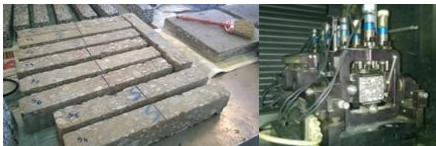
Figura 3.27 – Vigas e equipamento utilizado no ensaio do módulo de rigidez e de fadiga
