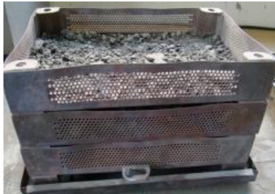
Figura 3.14 – Tabuleiro com amostra para determinação da percentagem de ligante do material fresado
