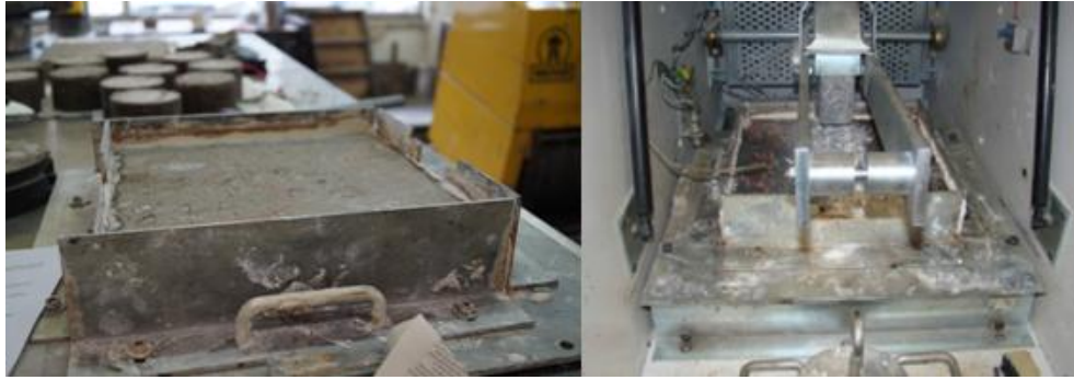
Figura 3.26 – Preparação do ensaio de pista para avaliação da deformação permanente
