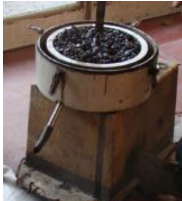
Figura 3.16 – Centrifugadora usada na 1ª fase do processo de recuperação de betume
