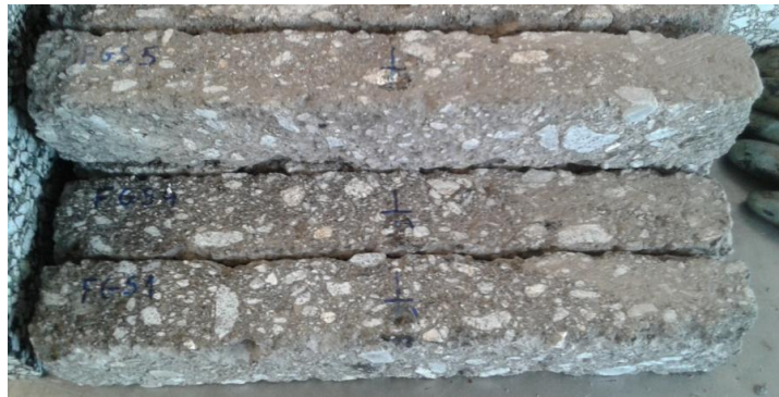
Figura 4.18 – Desagregação evidente das vigas com 50% material granular + 50% material fresado
