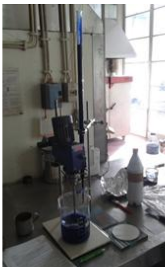
Figura 3.12 – Preparação da solução corante para o ensaio de azul-de-metileno
