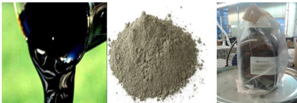
Figura 3.2 – Betume 50/70 (esquerda), cimento (centro) e aditivo TEGO (direita) utilizados neste trabalho
