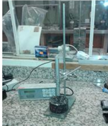
Figura 3.24 – Aparelho para determinar as dimensões dos provetes para cálculo da baridade aparente pelo método D
