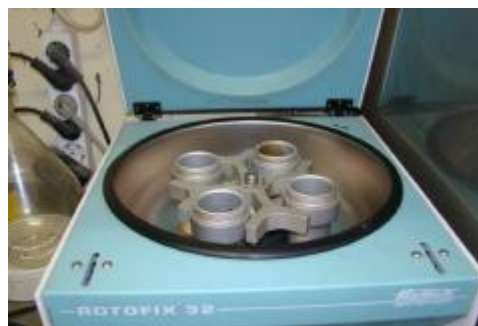
Figura 3.17 – Centrifugadora de precisão usada na 2ª fase de recuperação do betume
