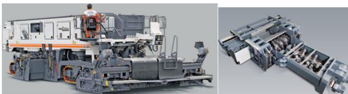
Figura 2.16 – Mecanismos de injeção e fresagem da recicladora a frio modelo WR 4200 da Wirtgen (Wirtgen, 2012)
