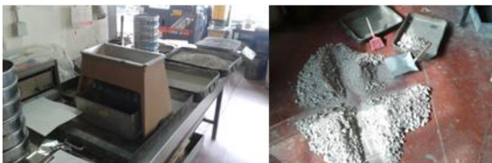
Figura 3.9 – Redução (esquerda) e espartilhamento (direita) da amostra de material granular
