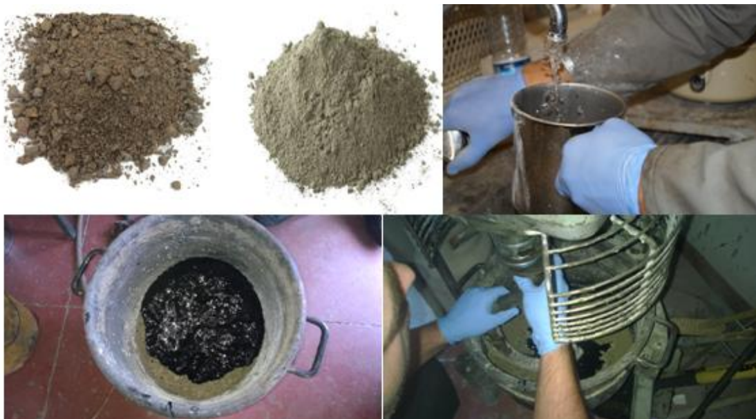
Figura 3.19 – Produção da mistura estabilizada com 100% material granular
