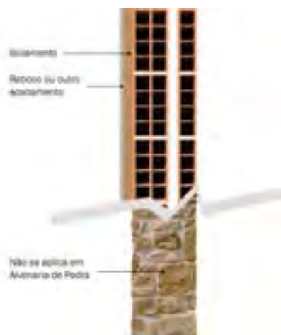
Figura 3. Pormenor construtivo de isolamento em parede exterior
