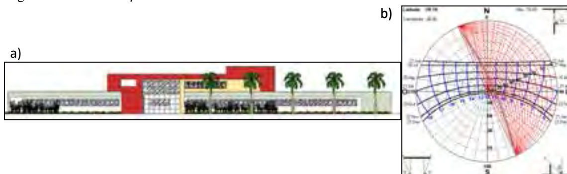
Figura 1. (a) Fachada Nordeste (b) Carta Solar - Fachada Nordeste. Sol-AR, 2017 e PMS, 2012.
