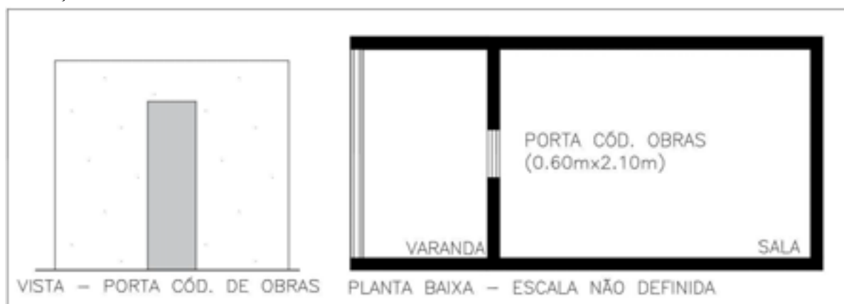
Figura 4. Vista e planta baixa esquemáticas do ambiente interno simulado, de acordo com o Código de Obras de Vitória. Fonte: elaborado pelas autoras (2017).
