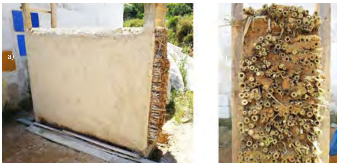
Figura 1. Protótipo 1: (a) Vista de sul com revestimento em reboco de cal; (b) Detalhe da vista de topo com a disposição da pasta com base em terra e fibras e das canas, com superfícies alinhadas pelos cimbres verticais de madeira
