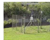
Fig. 9 Vista Sul da Estação Meteorológica, que monitora os elementos do clima: temperatura e umidade relativa do ar; radiação solar; pluviosidade; direção e velocidade dos ventos
