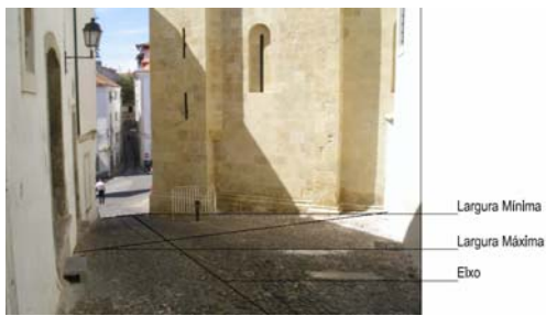
Figura 8 – Representação no espaço do processo de medição das Larguras
