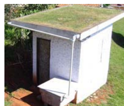
Fig. 4 Protótipo CVL com sistema automático de aquisição de dados, sensores de temperatura, e com sistema de coleta para a avaliação de reuso de água
