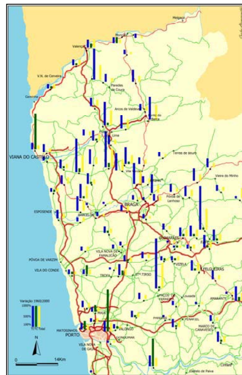
Fig. 2 Variação do TMDA (automóvel, transporte colectivo e total de motorizados) entre 1960 e 2000 no NW de Portugal
