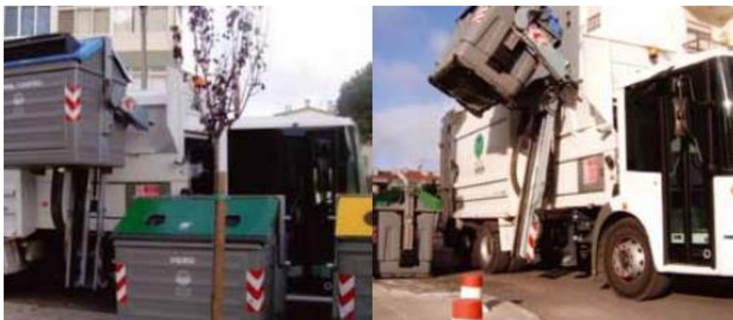
*Figura 9 Exemplificação de um processo de recolha lateral (Lavita, 2008).*
