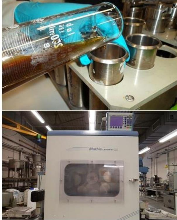
**Figura 16.** Colocação da solução para o processo de esgotamento (A) e equipamento Mathis Labomat (B).
