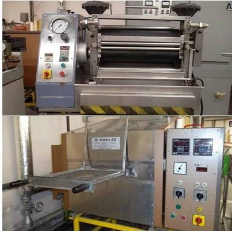
**Figura 15.** Representação dos equipamentos utilizados: Foulard Mathis (A) e a Secadeira Werner Mathis AG (B).
