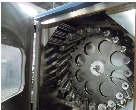
**Figura 14.** Equipamento Mathis Labomat utilizado nos pré-tratamentos e no processo de coloração.
