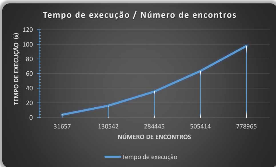
Figura 4.16 – Resultados dos testes de desempenho do algoritmo para extração de encontros (Tempo de execução / Número de encontros).
