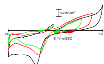
Fig. 1. Voltamograma cíclico do eléctrodo de platina em oleato de sódio 0,265M + NaOH 0,1M, com variação do limite de potencial anódico; u=100mVs -1
