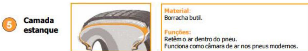
Figura 20 - Função e componentes da Camada estanque (Continental, 2016)
