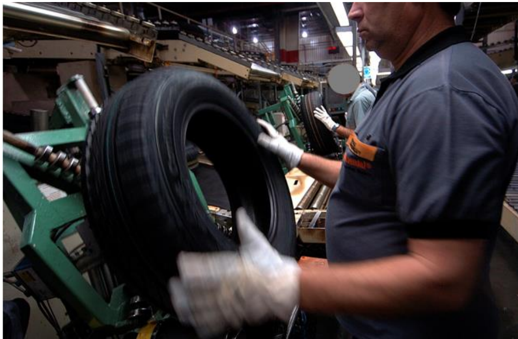
Figura 29 - Inspetores a efetuar inspeção visual (Continental, 2016)
