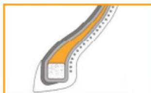
Figura 22 - Função e componentes da Cunha do talão (Continental, 2016)
