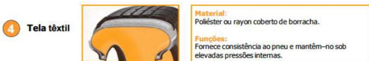
Figura 19 - Função e componentes da Tela têxtil (Continental, 2016)
