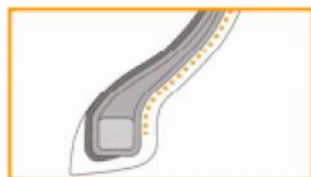
Figura 24 - Função e componentes do Reforço do talão (Continental, 2016)
