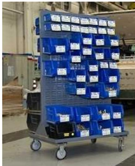
Figura 41 - Exemplo de carruagem para transporte das caixas de abastecimento de *spare parts*.
