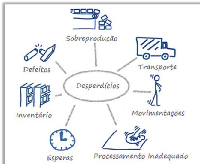
Figura 3 - Sete tipos de desperdícios em ambiente industrial (adaptado de <http://www.italiandirectory.ru/en/lean-manufacturing-the-7-critical-causes-of-waste/>).
