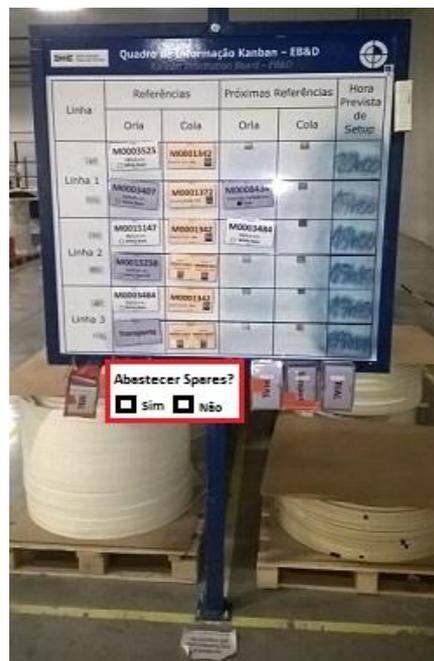
Figura 38 - Exemplo de possível sistema de notificação para abastecimento de *spare parts*.
