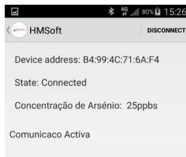
Figura 42- Conexão estabelecida e receção de dados do sensor.
