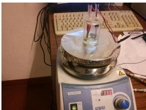
Figura 4-7: Agitador magnético
