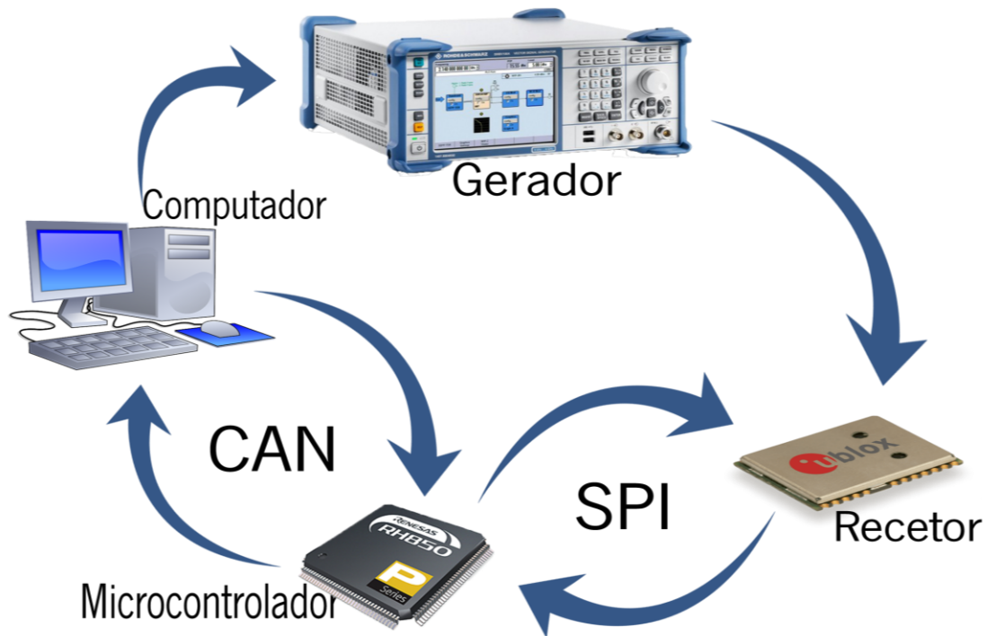
Figura 18 - Visão geral do sistema de teste GNSS
