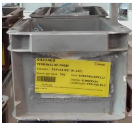
Figura 15 – Caixa de kanban interno do tipo 10C
