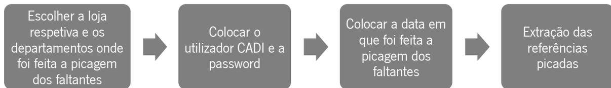
**Figura 22:** Funcionamento da ferramenta PIKAKÍ para análise dos faltantes.
