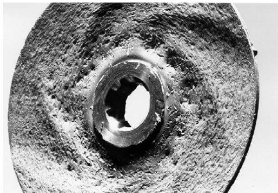
Figura 11 – Impulsor demonstrando estragos motivados por cavitação
