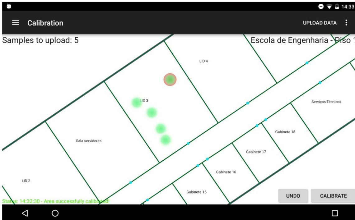
Figura 5.18: Ecrã de calibração com zoom - calibração de vários pontos
