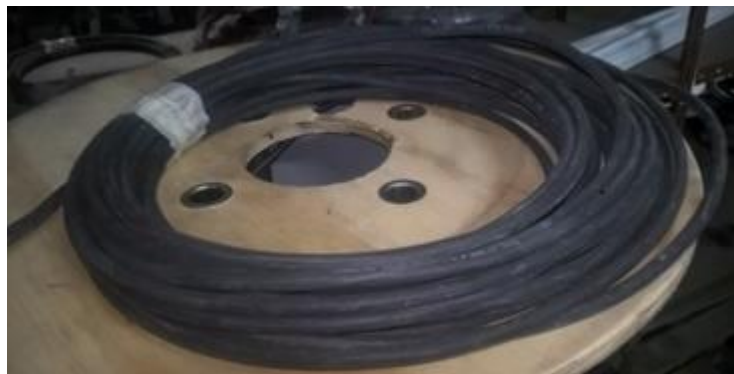
Figura 6.0.1 - cabo solar negativo 4 \text{ mm}^2 que liga os painéis ao inversor. Foto do autor.
