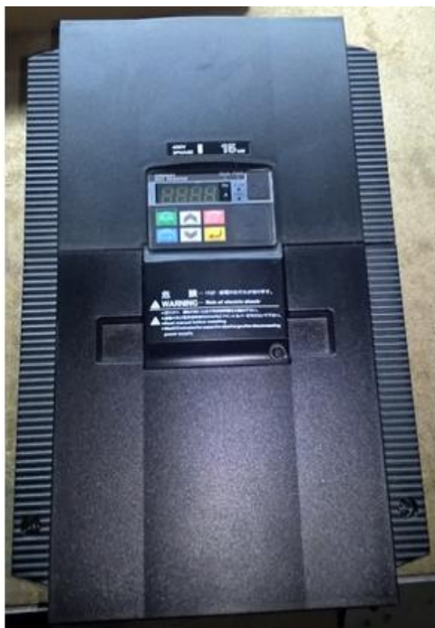
Figura 8.15 - variador de frequência OMRON MX2 trifásico 15 kW e 400 V usado na DAPE. Foto do autor.
