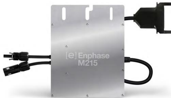
Figura 3.15 – microinversor Enphase M215. Do lado esquerdo tem os conetores MC4 negativo e positivo que ligam aos painéis, do lado direito tem o cabo de engate que faz a ligação a outros microinversores ou a uma ficha que liga ás tomadas ou ao quadro geral. [24]
