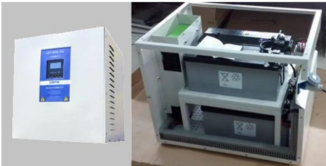
Figura 3.10 – armário com inversor MasterPower OMEGA EU e 4 baterias que fazem parte dos kits solares OASIS. Foto do autor.
