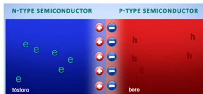
Figura 2.24 – íons positivos e íons negativos ao longo da junção metalúrgica. [12]
