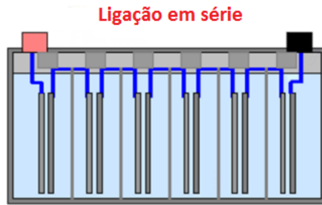
Figura 4.3 - Ligação em série de 6 células chumbo-ácido de uma bateria. [5]
