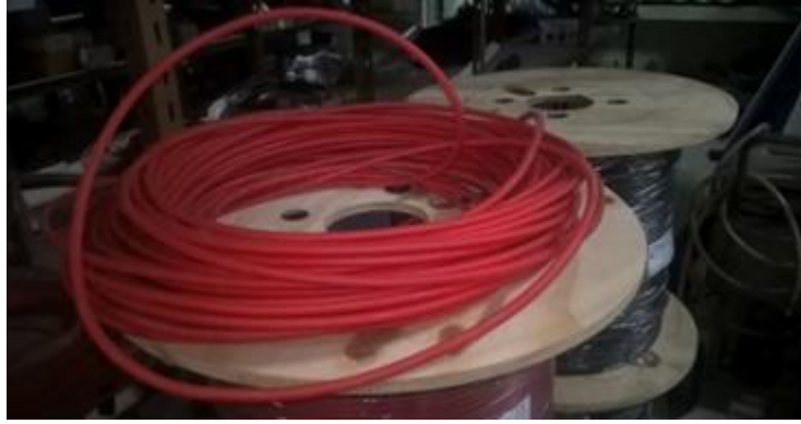
Figura 6.2 – cabo solar positivo de 4mm 2 que liga os painéis ao inversor. Foto do autor.
