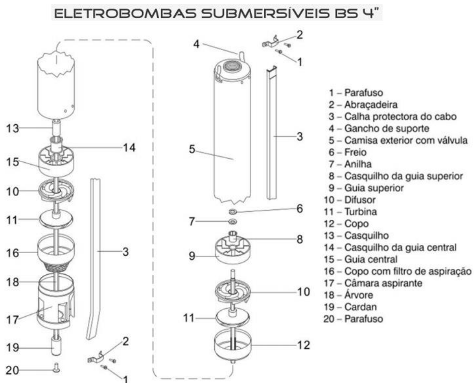
Figura 8.8 – Constituição de uma eletrobomba submersível centrífuga. [8]
