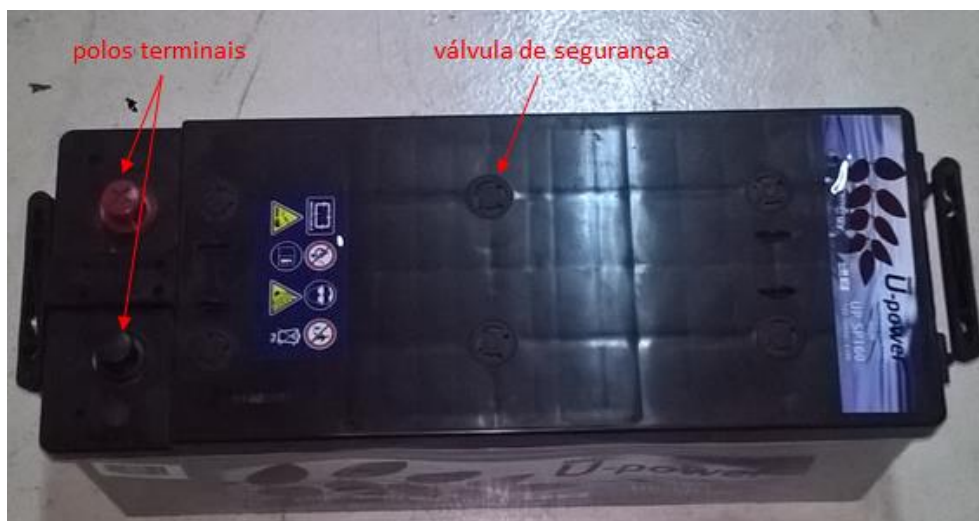
Figura 4.7 – Válvulas de segurança da bateria VRLA da Master U-power AGM UP-SP160 12V-160Ah/C100. Foto do autor.
