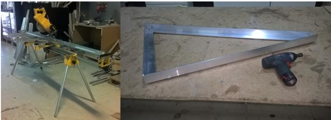
Figura 6.7 - corte e montagem de uma estrutura de suporte em alumínio. Foto do autor.
