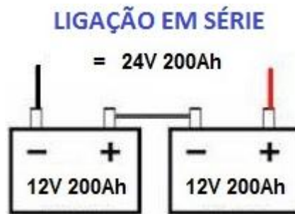
Figura 4.24 - Ligação em série de baterias. [26]
