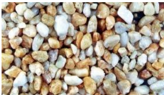
Figura 8.4 - pré-filtro de areão calibrado. [11]
