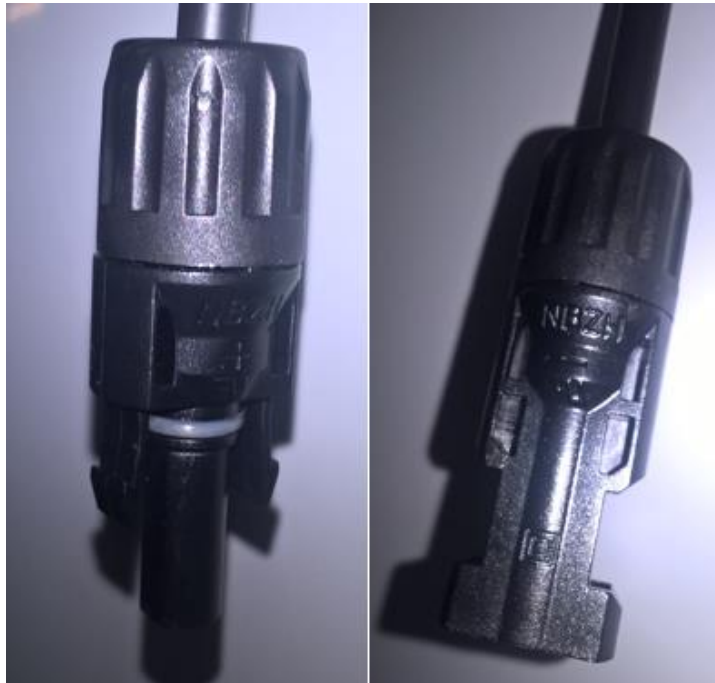
Figura 2.65 – conector solar MC4 positivo ou macho (á esquerda), conector solar MC4 negativo ou fêmea (á direita). Foto do autor.
