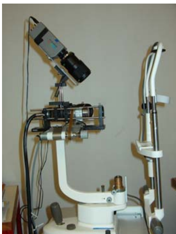
Figura 6.1: Imagem do equipamento desenvolvido para a determinação da espessura e da topografia da córnea.
