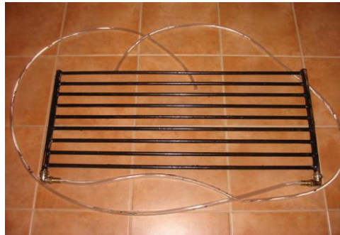
Figura 15: Fotografia do circuito por onde passa a água.
