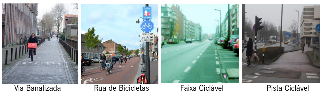
Figura 7: Tipos de Vias Cicláveis. Fonte: Fotografia Própria, CROW (2007) e IMTT (2011b)
