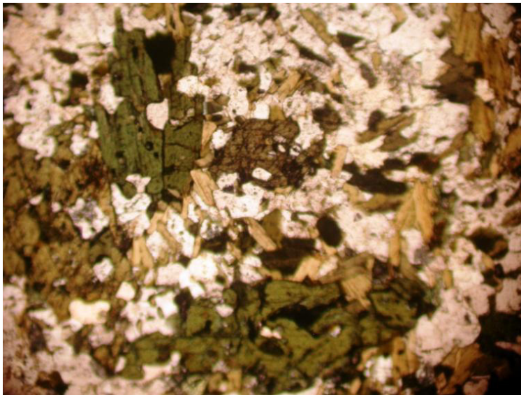
Figura 5.30. Microfotografia, em LPNA, de pseudomorfose de clorite após anfíbola, observada nos anfibolitos do Licungo. Nota: Cristais de biotite são prismáticos; na parte branca encontram-se cristais de quartzo e alguma plagioclase.
