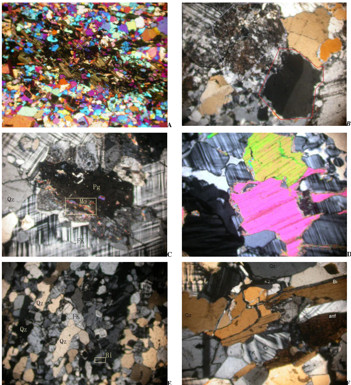
Figura 5.5. Microfotografias de feições texturais e mineralógicas comuns nos gnaisses do Licungo. Imagens em LPA-MOLT. A – Gnaisse equigranular bandado, com bandas essencialmente biotíticas; B – gnaisse com plagioclase em desequilíbrio (inscrito em polígono branco) e albite com maclas simples (em polígono vermelho); C - gnaisse com plagioclase em alteração, observando-se margens coroníticas; a moscovite e algum quartzo secundários observam-se por entre planos de macla; D - gnaisse com moscovite e quartzo desenvolvidos a partir do preenchimento de fracturas; a moscovite e microclina apresentam extinção ondulante; E – gnaisse com margens estáveis e orientação preferencial generalizada dos grãos; F – gnaisses com alongamento e orientação preferenciais dos grãos de hornblenda, quartzo e biotite. O comprimento de cada fotografia é de cerca de 3 mm.
