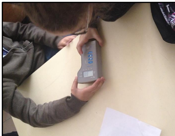
Figura 15 – Atividade experimental com o decibelímetro
