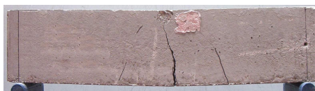
Figura 11: Rotura por flexão
