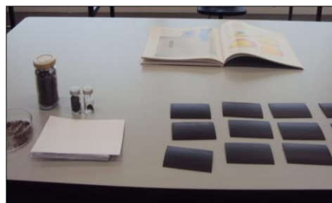
Figura 17 – Areia da Praia Grande de Sintra contendo ilmenite. Através da utilização de ímanes, os alunos puderam comprovar o carácter magnético deste mineral.
