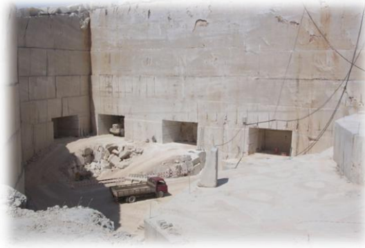
Figura 45 – Fotos da vista geral de uma pedreira utilizando o método de exploração subterrânea ( adaptado de Nunes, 2010 ).
