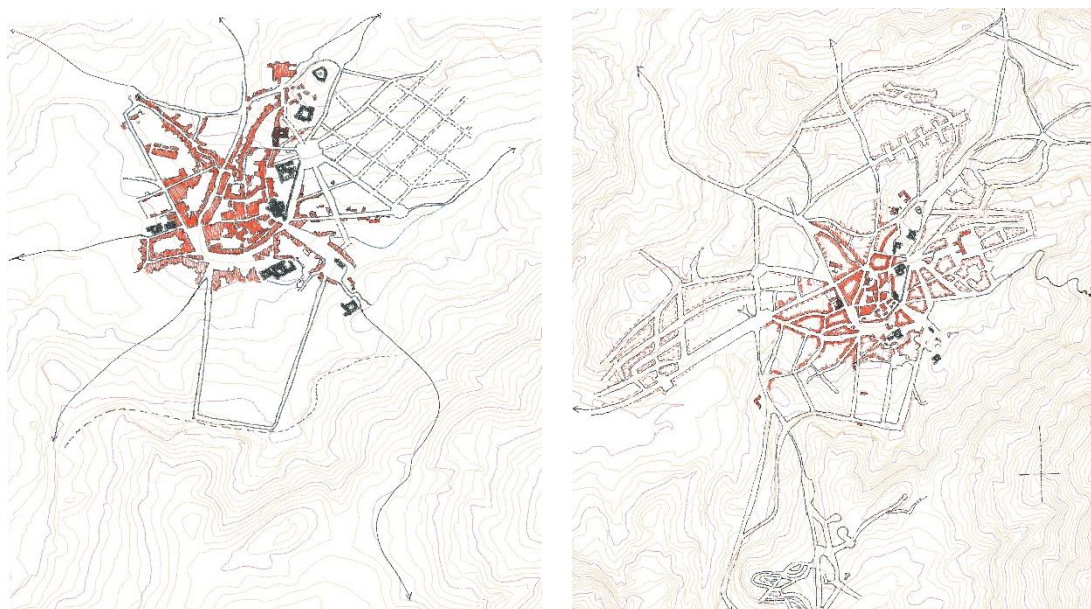
Figura 2. Esquemas da expansão urbana de Guimarães: vias abertas em consequência da nova ligação ferroviária e dos planos de 1867 e 1925 (esquerda) e expansão prevista no plano de 1953 (direita). Desenhos de Eduardo Fernandes a partir de Pina (1925) e Silva; Silva (1953).
