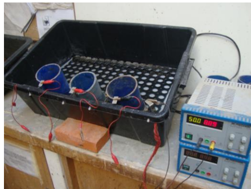
Figura 3. Realização do ensaio de difusão de cloretos por migração.
