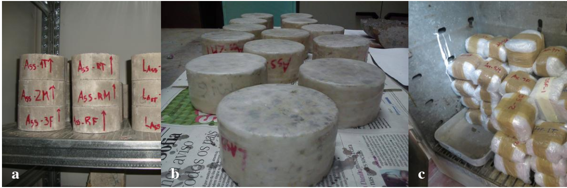
Figura 2. a) Provetes na câmara com temperatura e humidade controladas b) Provetes pitados com parafina c) Provetes na estufa 40°C.
