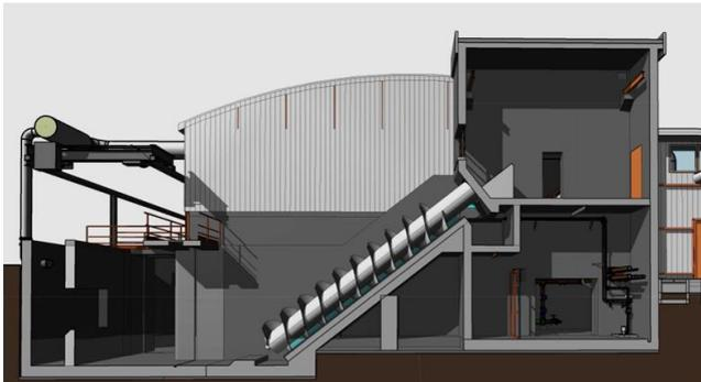
Figura 5: Elevação - Corte perspetivado.
