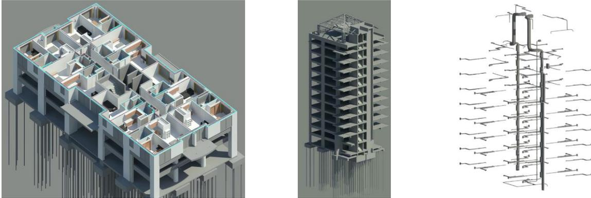
Figura 4: Modelos BIM (Arquitetura, Estruturas e MEP).
