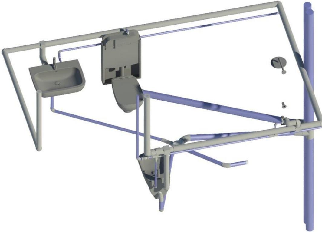
Figura 2: Casa de banho implementada em Revit.
