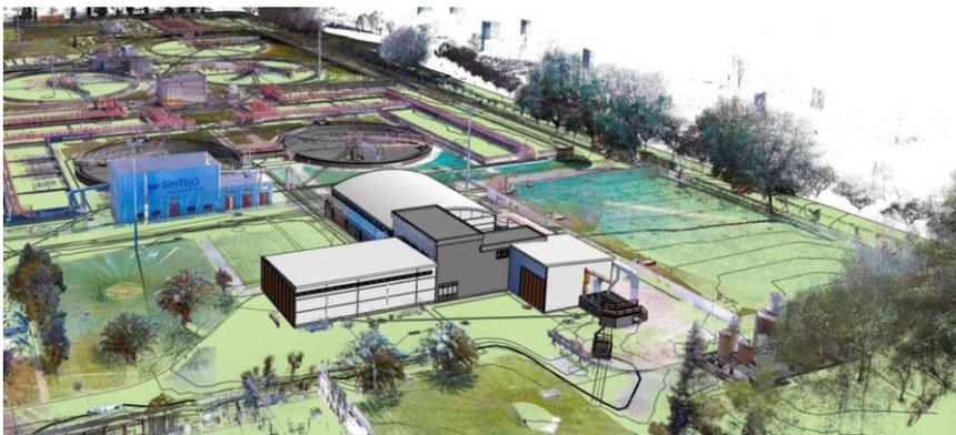
Figura 1: Sobreposição do modelo da ETAR e da respetiva nuvem de pontos.
