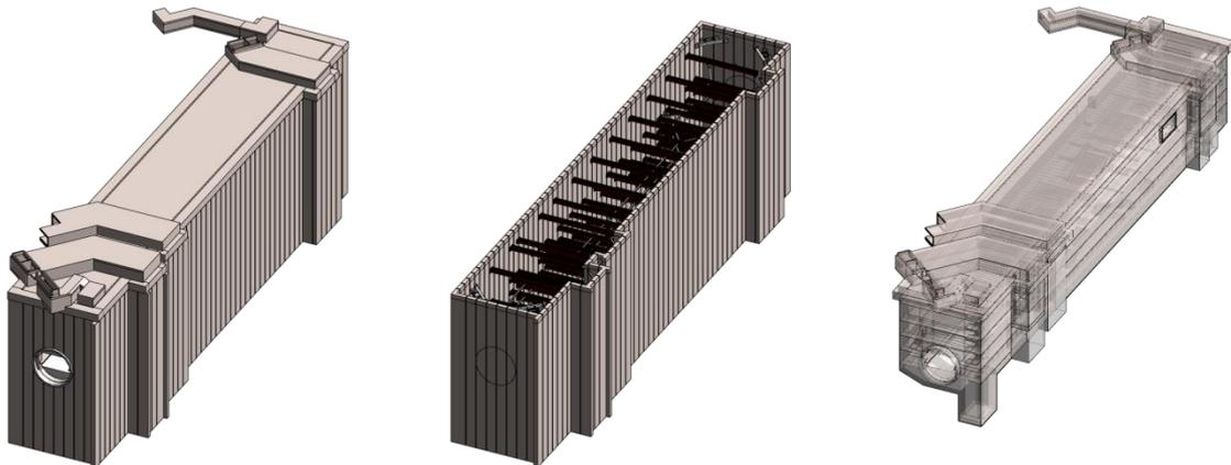
Figura 3: Modelos desenvolvidos no âmbito do projeto-piloto. Da esquerda para a direita: modelo de coordenação, modelo da geotecnia, modelo de estruturas.
