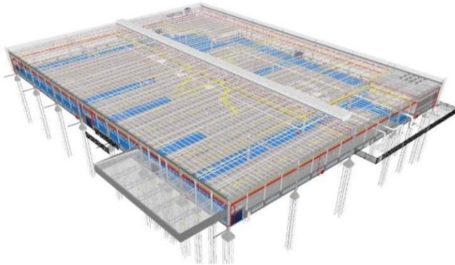
Figura 1: Modelo BIM de Estruturas.
