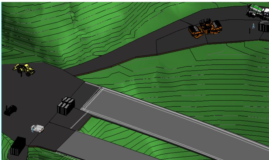
Figura 6: Distribuição das instalações e equipamentos do estaleiro nascente.
