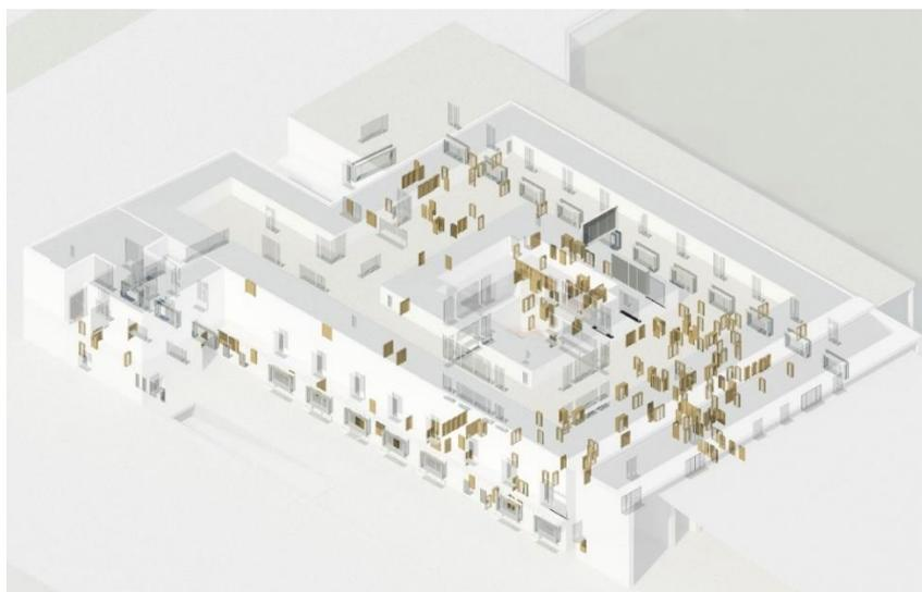
Figura 7: Visualização tridimensional de portas e janelas num Modelo Integrado [5].
