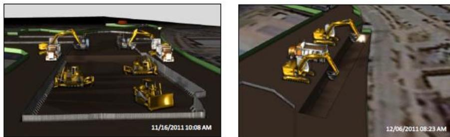
Figura 2: Simulação de escavação 4D retratando instalações de estacas-pranchas e tubo (Fonte: [6])
