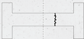
3 rd crack – 242h
