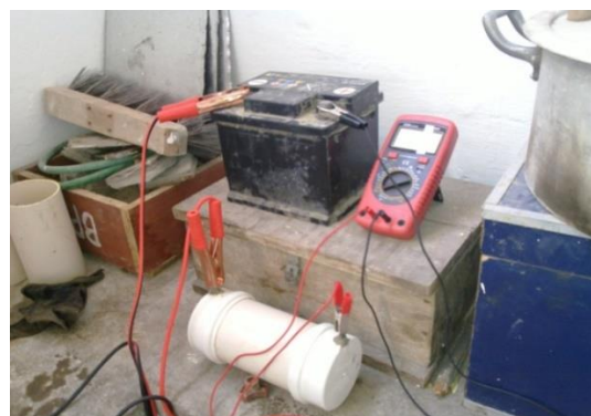
Figura 4: Ensaio de resistividade elétrica
