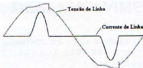
Fig. 2 - Distorção provocada por rectificador.
