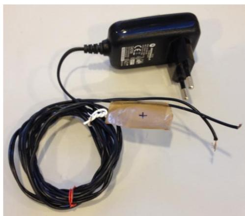
Figura 4.9 – Fonte de tensão CC de 5V.
