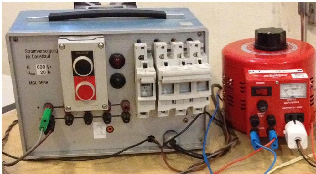
Figura 5.1 - Conjunto utilizado para substituir o painel solar fotovoltaico.
