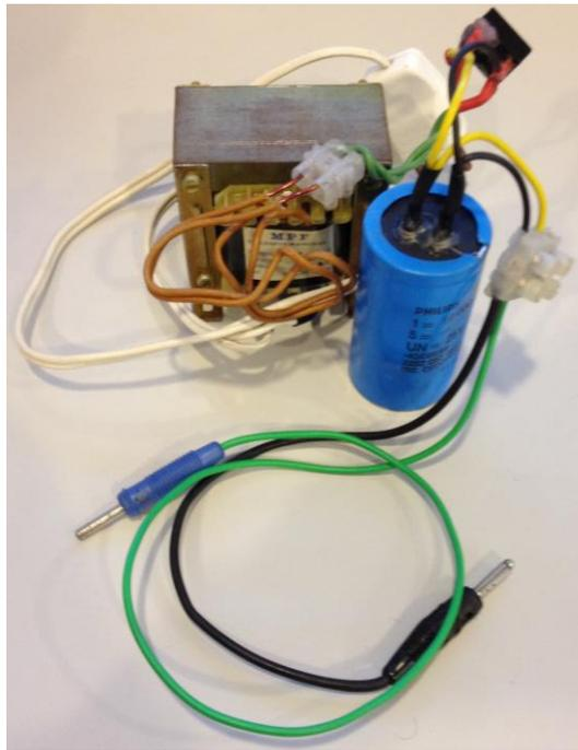
Figura 4.10 – Fonte de tensão CC de 16V.
