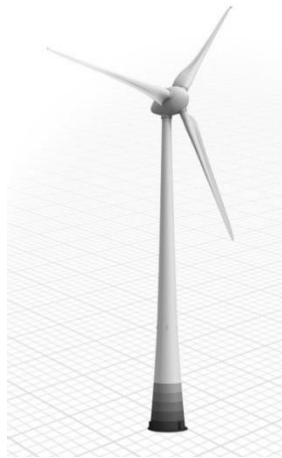
Figura 2.5 – Turbina eólica de eixo Horizontal (HAWT) [16].
