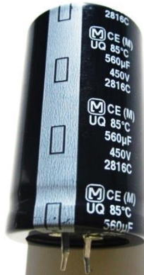
Figura 5.12 - Condensador utilizado à saída do step-up .
