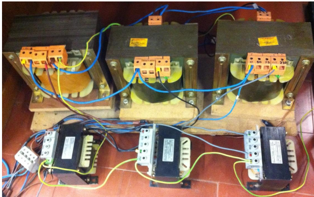
Figura 6.2 – Transformadores de isolamento e as bobinas de acoplamento.
