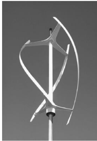
Figura 2.4 – Turbina eólica Gorlov Helica [13].
