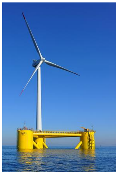
Figura 2.13 – Turbina eólica offshore instalada ao largo da costa da Aguçadoura [20].
