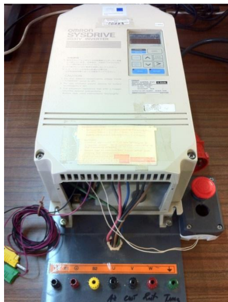
Figura 5.2 – Variador de velocidade Sysdrive 3G3IV da OMRON .
