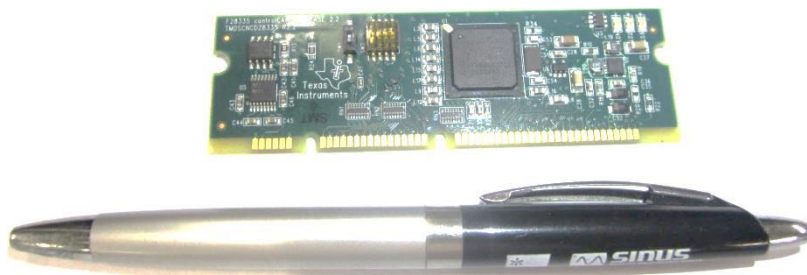
Figura 5.22 – Placa de controlo TMDSCNCD28335 da Texas Instruments .
