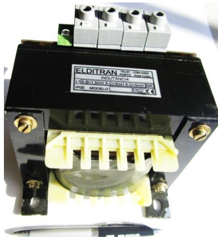
Figura 5.15 – Bobina de acoplamento utilizada.
