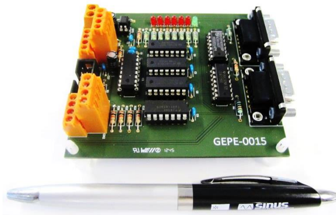
Figura 5.26 - Circuito de Comando Monofásico.
