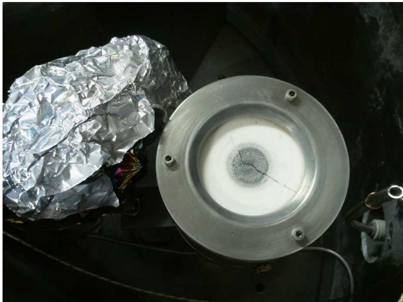
**Figura 19 - Equipamento *Rf Magnetron Sputtering*, com alvo de LiPON no interior da câmara de deposição.**
