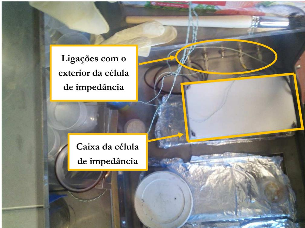
Figura 36. Célula de impedância durante um teste de temperatura.
