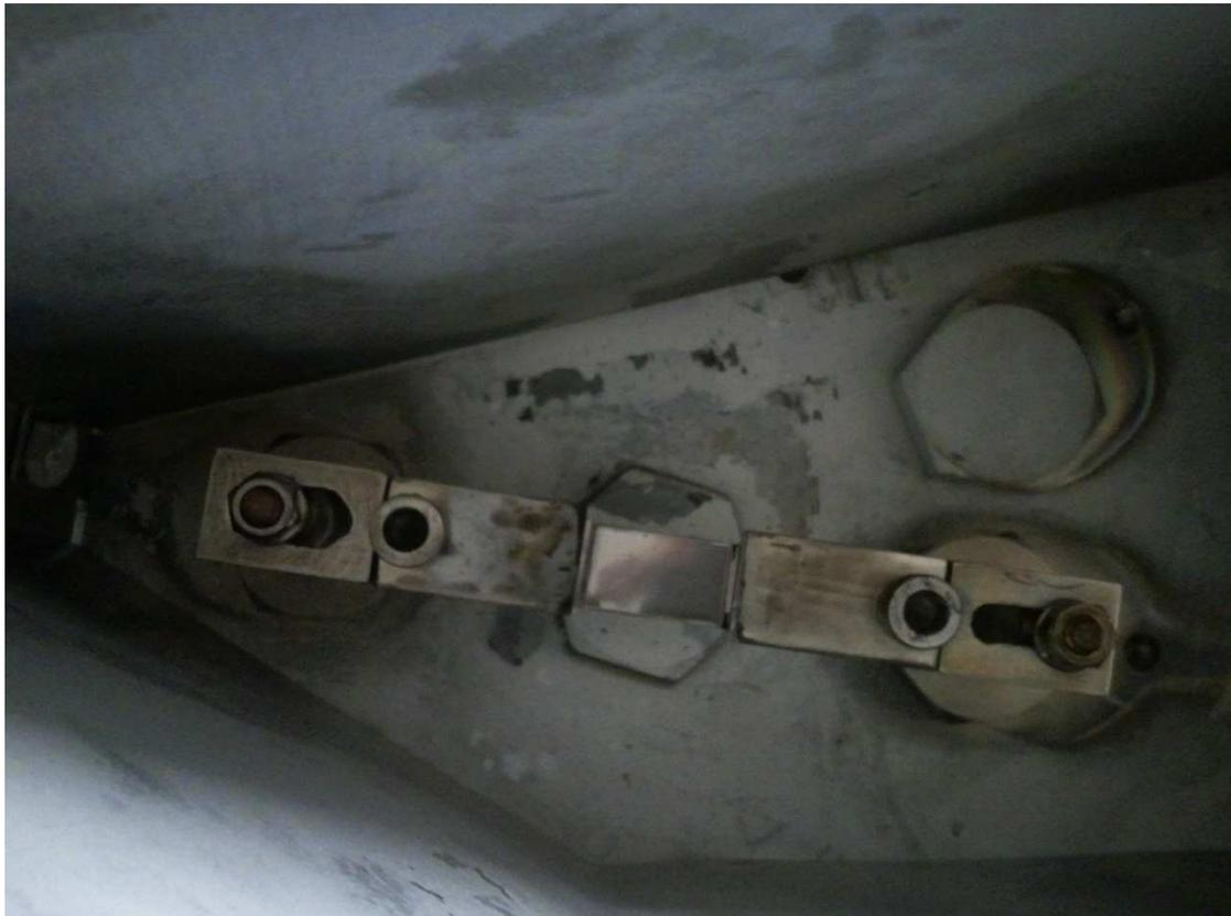
**Figura 15 - Evaporação térmica, imagem do interior da câmara de deposição.**
