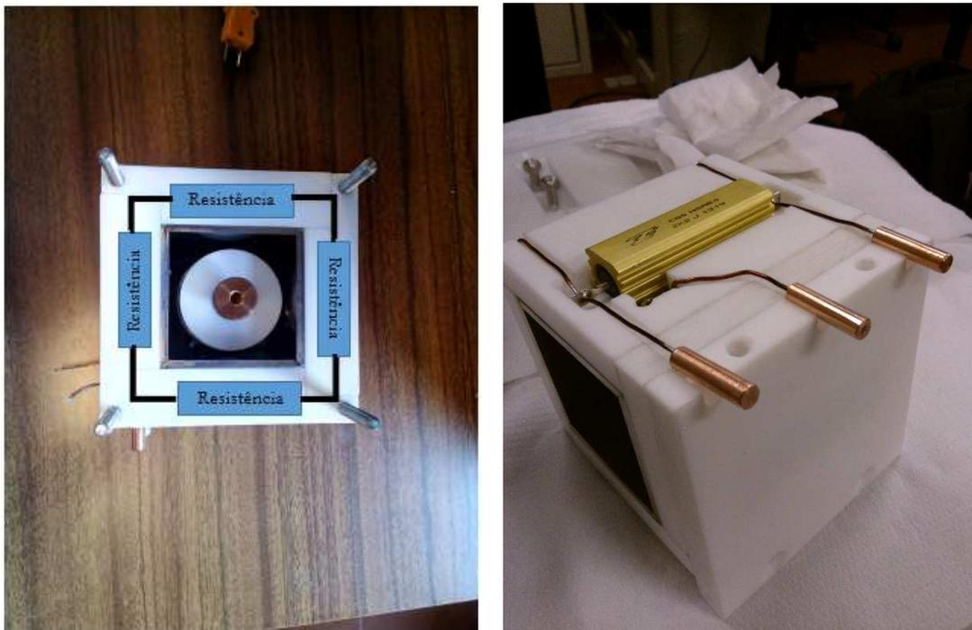
Figura 33 - Caixa de aquecimento da célula de impedância, com indicação da localização das resistências de aquecimento.
