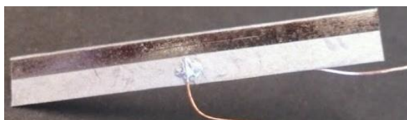
Figura 3.12 - Vista de Topo da Amostra ME (Metglas/PVDF/Metglas).
