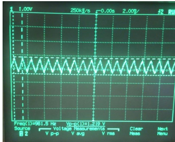
Figura 4.15 - Campo magnético terrestre lido no osciloscópio à saída da resistência AMR.
