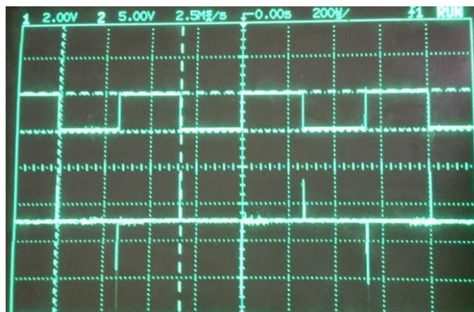
Figura 4.14 - Pulsos gerados após conexão ao sensor AMR.
