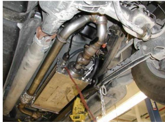
Figura 2.3-5 Implementação do gerador termoelétrico no modelo *Chevrolet*[15].
