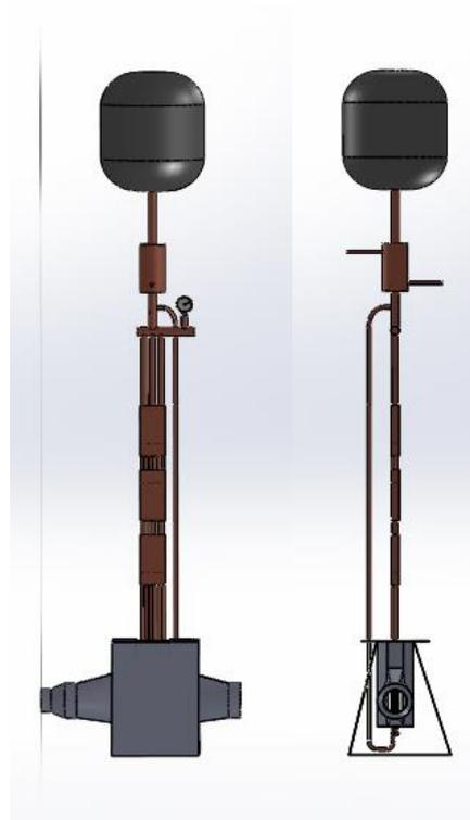
**Figura 5.2-2** Modelo em *SolidWorks* do gerador termoelétrico atual.
