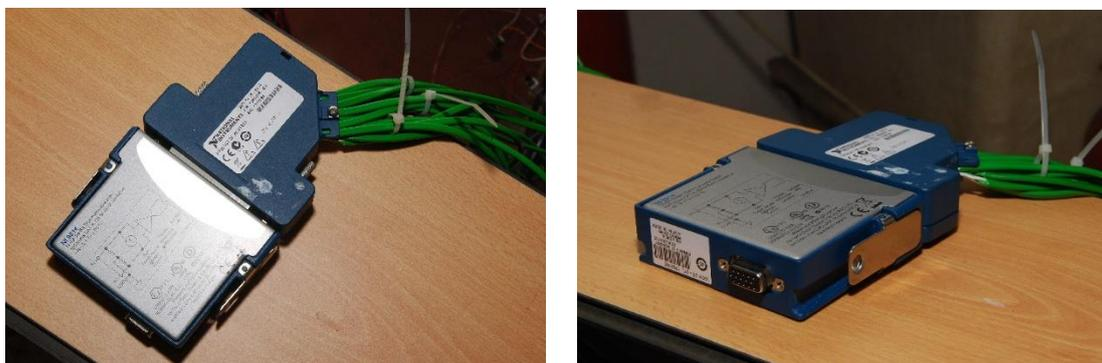
Figura 5.3-1 Placa da *National Instruments*, *NI 9214* para aquisição do sinal dos termopares e medição da temperatura.
