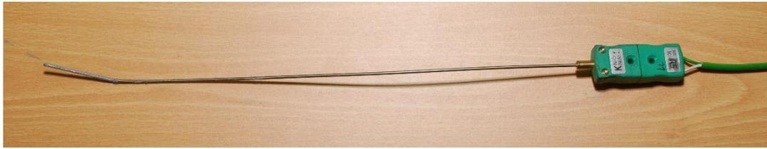
Figura 5.3-2 Termopares tipo K da RS que foram usados para a medição de temperaturas.
