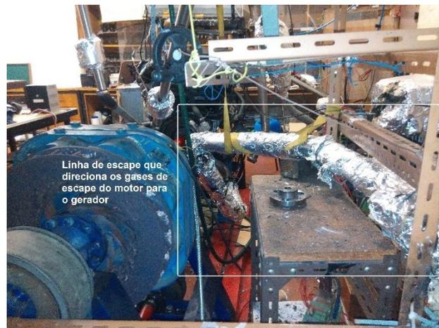
**Figura 5.4-3** Linha de escape que direciona os gases de escape do motor para gerador termoelétrico.
