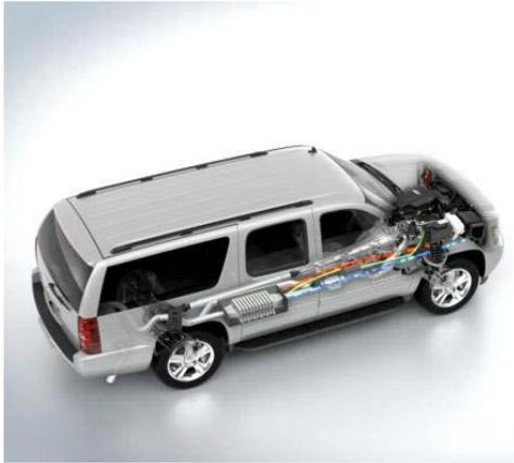
Figura 2.3-6 Modelo *Chevrolet* com o sistema gerador termoelétrico implementado[15].
