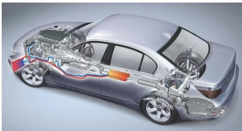
Figura 2.3-2 Modelo *BMW* 530i com o gerador termoelétrico.
