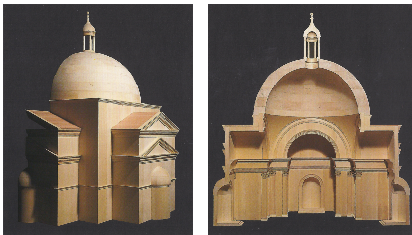
Figura 94. Maquetes de madeira representando a pretensa proposta de Alberti para o Templo Malatestiano. Maquetes construídas pelo Alberti Group para a exposição Leon Battista Alberti , Palazzo Te, Mântua, 1994.. Fotografias atribuídas a Giovetti, fonte: (Tavernor R. W., 1998, p. 129).
