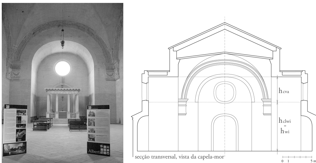
Figura 56. Igreja de São Sebastião: à esquerda, fotografia do interior da nave, lado Sul; à direita, parte do alçado do interior da nave, colocando em evidência relação entre a altura das paredes das capelas laterais e as paredes da nave.
