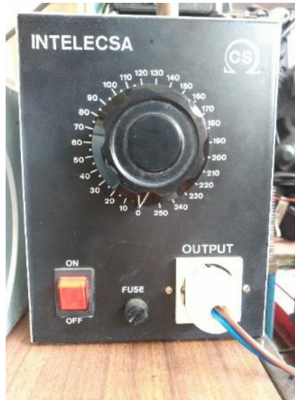
Figura 78 - Controlador de corrente fornecida ao freio (Variac)
