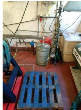
Figura 48 - Suporte, barra e pesos totais usados na calibração da célula de carga
