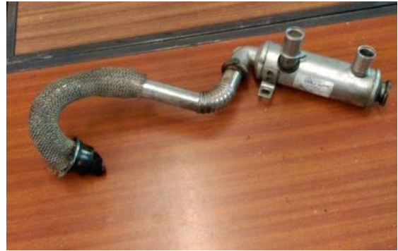
Figura 29 - EGR cooler removido
