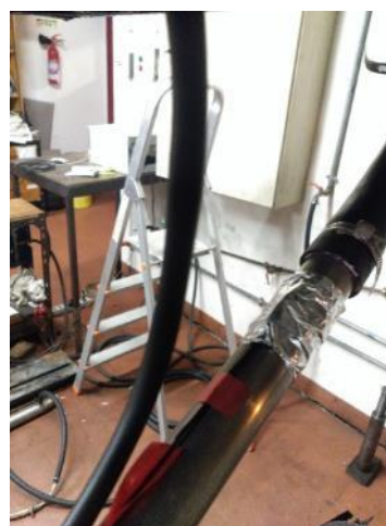
Figura 57 - Termopar colocado no tubo de saída do líquido de arrefecimento
