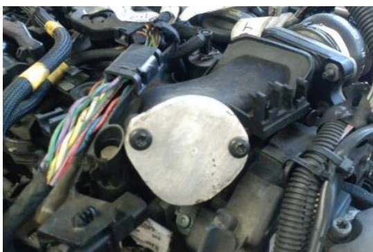
Figura 33 - Desativação de outra entrada para o sistema EGR
