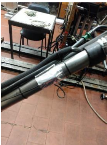
Figura 56 - Termopar colocado no tubo de entrada do líquido de arrefecimento
