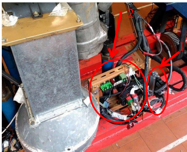
Figura 66 - Circuito de gestão eletrónica do motor ( 1- ECU, 2- Caixa de fusíveis (PSF) )
