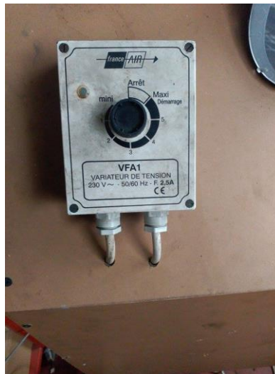
Figura 63 - Controlador do ventilador
