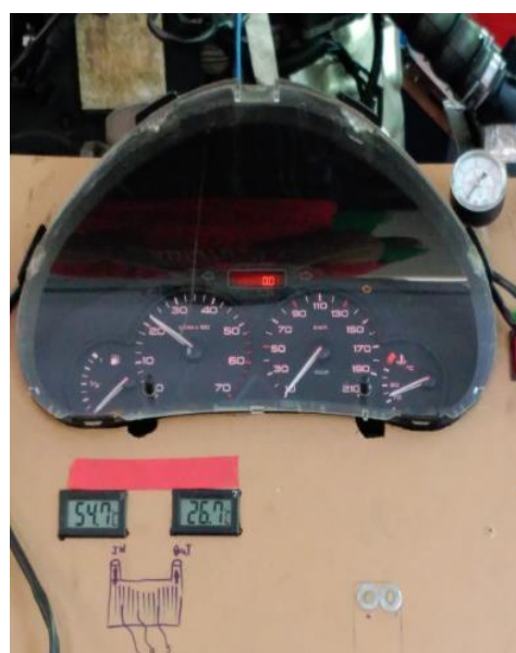
Figura 59 - Nova disposição dos displays dos termopares no painel de instrumentos
