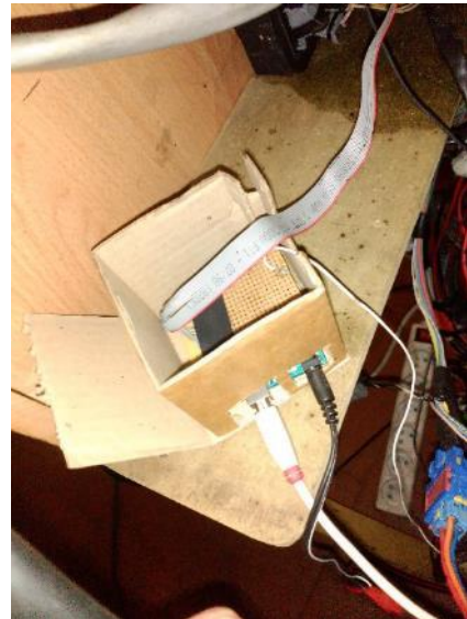
Figura 53 - Suporte para o Arduino na instalação
