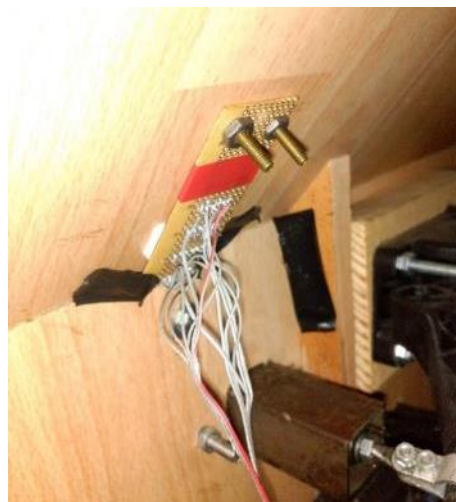
Figura 55 - Ligações e parte de trás do display de carga do acelerador
