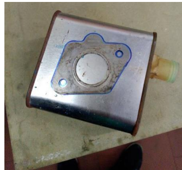
Figura 31 - Desenho da parte exterior da junta numa lata de diluente para posterior uso
