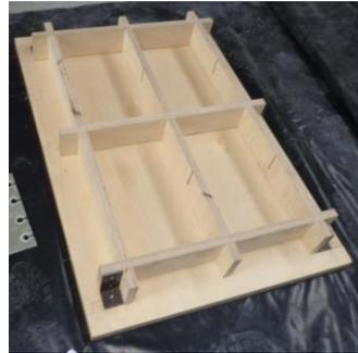
Figura 3.4 Fixação das tábuas divisórias móveis à placa de madeira
