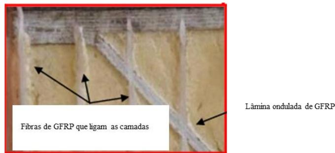
Figura 2.14 Pormenor da ligação entre camadas do painel sandwich desenvolvido por (Sopa et al., 2012)
