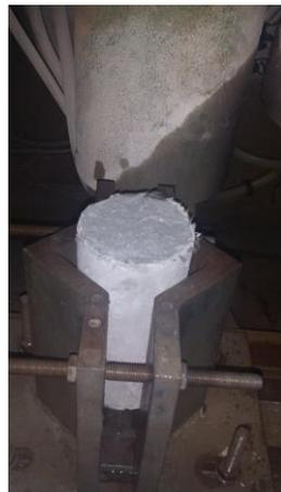
e) Provete cilíndrico antes da regularização
