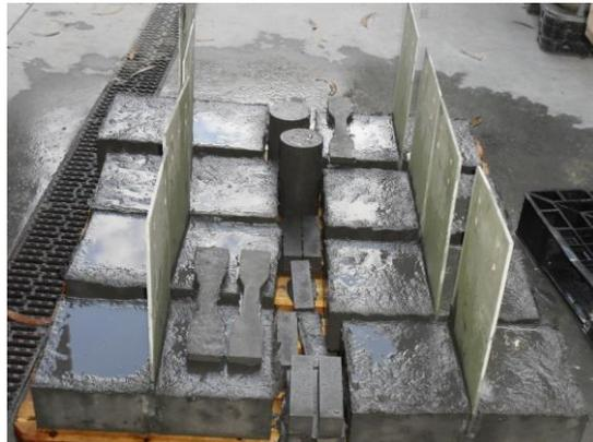
Figura 3.8 Aspeto dos provetes após desmoldagem
