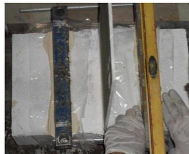
b) Nivelamento da superfície de apoio
