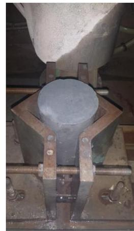
f) Provete cilíndrico depois da regularização
