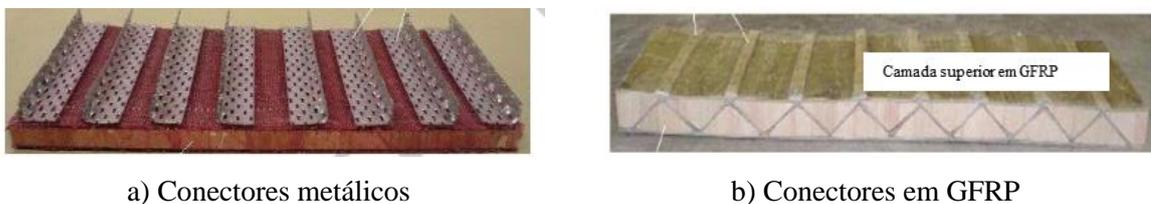
Figura 2.15 Conectores dos painéis sandwich desenvolvidos por (Norton, 2004)
