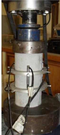
Figura 3.25. Montagem do ensaio para determinação do módulo de elasticidade
