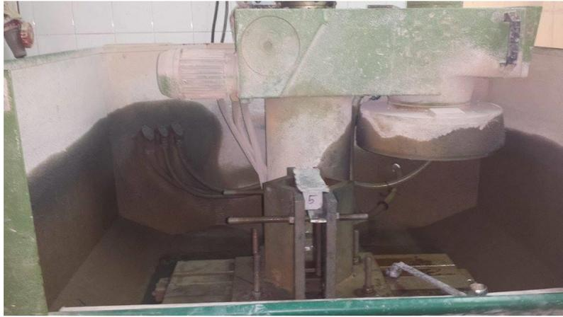
a) Máquina utilizada para regularização dos provetes
