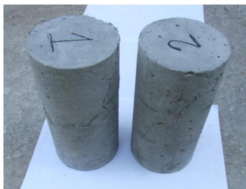
c) Rotura dos dois cilindros ensaiados
