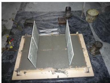
c) Configuração do molde *pull-out* após a regularização da superfície
