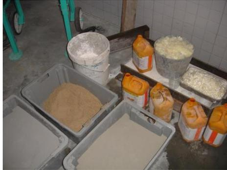
Figura 3.9 Materiais nos recipientes utilizados para produção da argamassa DHCC
