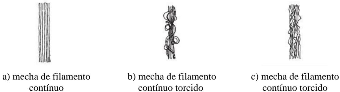
Figura 2.17 Configuração das mechas de filamentos
