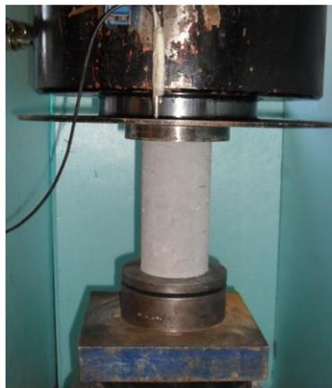
Figura 3.26 Montagem do ensaio de compressão
