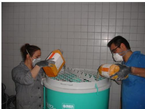
Figura 3.11 Adição de água e superplastificante
