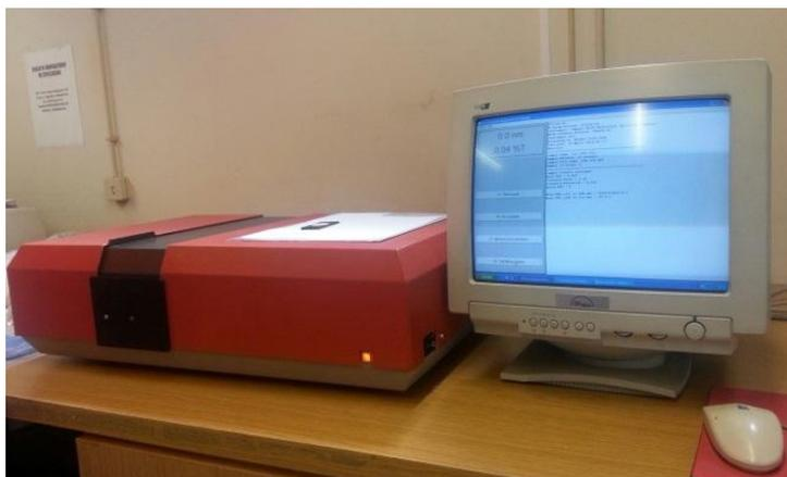
Figura 33 Equipamento utilizado para a medição do UPF, espectrofotômetro UV- VIS (UMinho)
