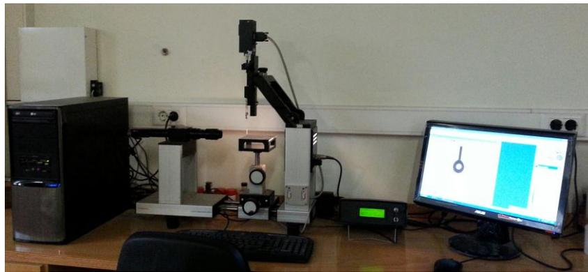
Figura 32 Equipamento para a medição do ângulo de contato
