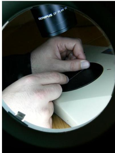
Figura 26 Identificação da torção do fio
