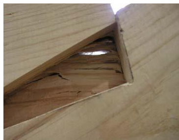
Figura 93 - Falha da respiga ao fechar o ângulo de inclinação (Palma, et al., 2007).
