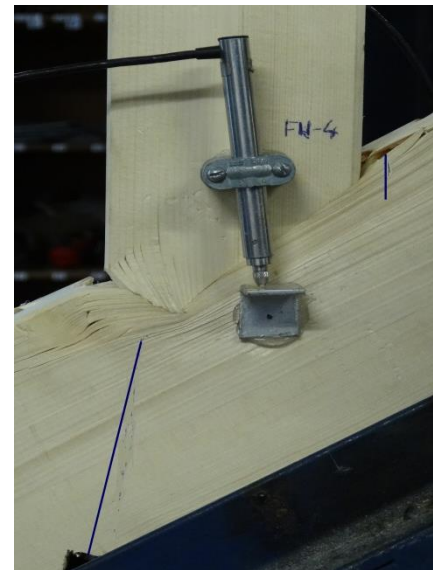
Figura 122 - Ligação reforçada com 2 parafusos auto-perfurantes: a) gráfico força-deslocamento da ligação sem reforço e com reforço; b) modo de falha da ligação reforçada.
