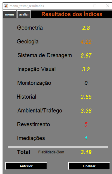
Figura 30 – Resultados finais do talude em estudo.
