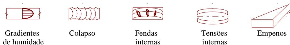
**Figura 2.8:** Tipos de defeitos causados ou agravados por uma deficiente operação de secagem (Santos et al., 2011, Fig. 5).
