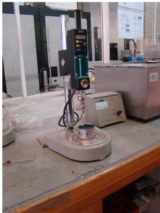
Figura 12 - Ensaio de penetração com agulha
