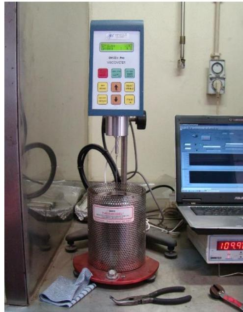
Figura 15 - Ensaio de viscosidade através do viscosímetro rotacional *Brookfield*
