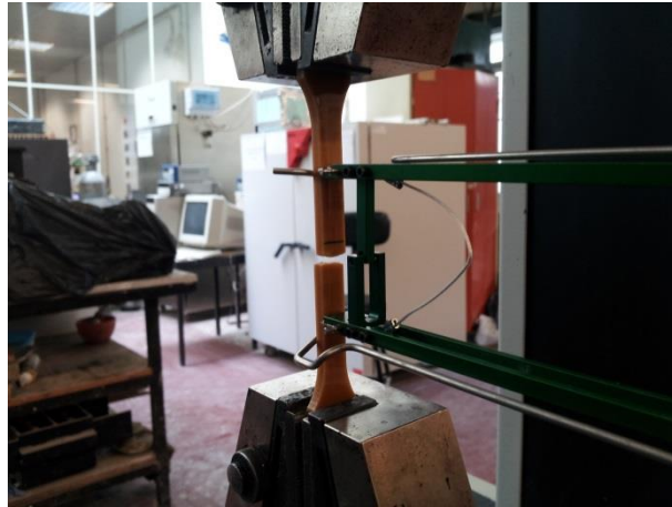
Figura 5: Rotura de um provete de epóxy ensaiado à tração.
