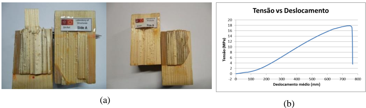
Figura 39: (a) Modo de rotura do ensaio de corte da condição TH=8%. (b) Gráfico Tensão vs Deslocamento.
