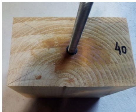
Figura 20: Provete para ensaio de arrancamento Pull-out .
