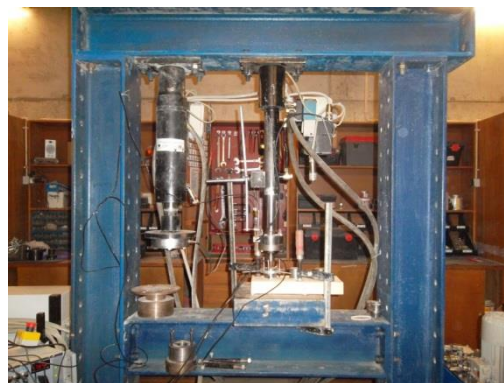
Figura 50: Equipamento utilizado para o ensaio de pull-off .
