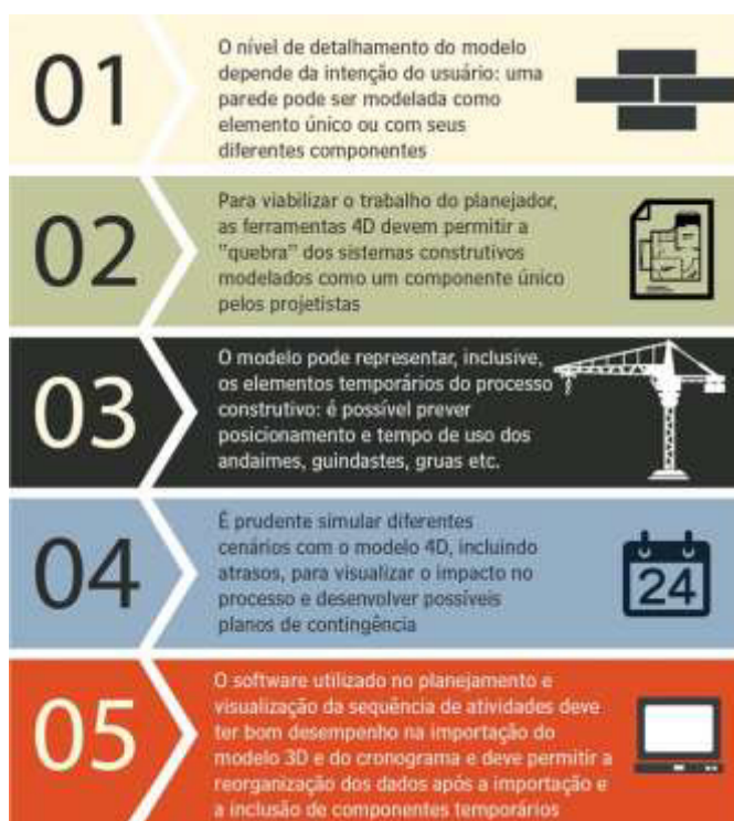
Figura 2.5 – Etapas da modelação BIM (Fonte: GBC Engenharia, 2015)
