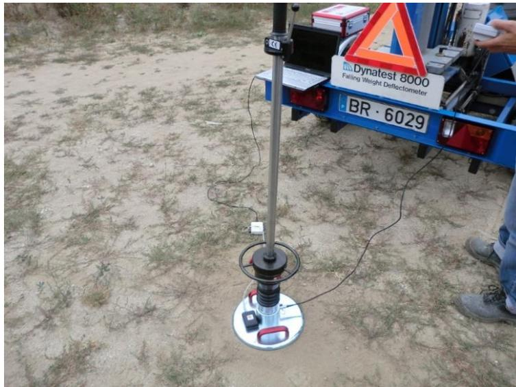
Figura 34 - Preparação do Defletómetro de Impacto Ligeiro (LFWD) para o ensaio
