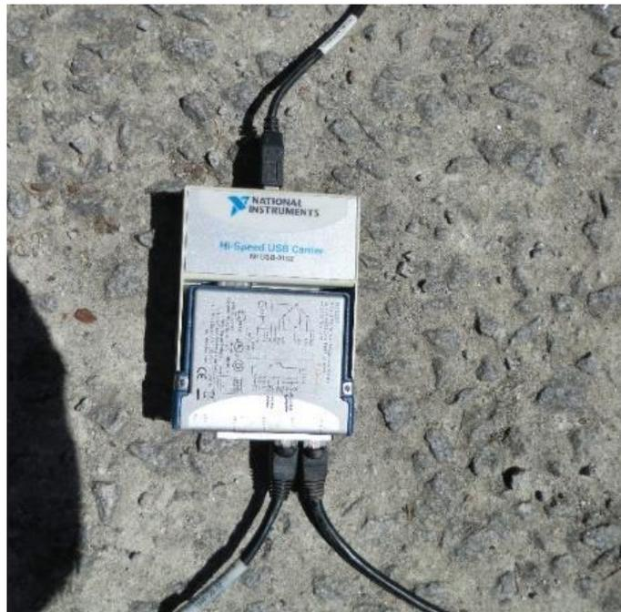
Figura 29 - Dispositivo de aquisição de dados
