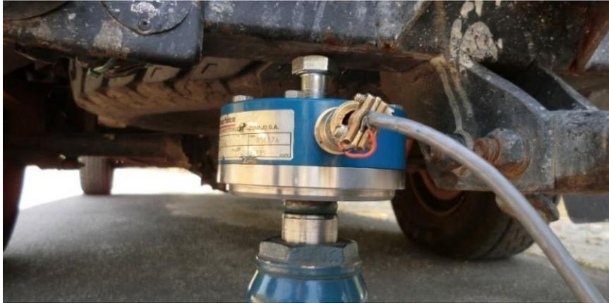
Figura 39 - Pormenor do sistema de medição de carga (célula de carga)
