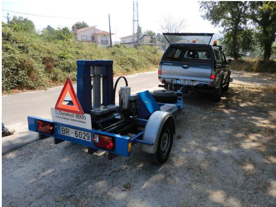
Figura 32 - Execução de medição com FWD (1ª fase)
