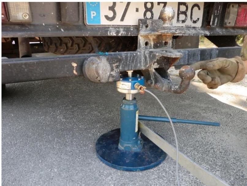
Figura 38 - Colocação da placa sob o veículo e posicionamento da ponta apalpadora da viga Benkelman
