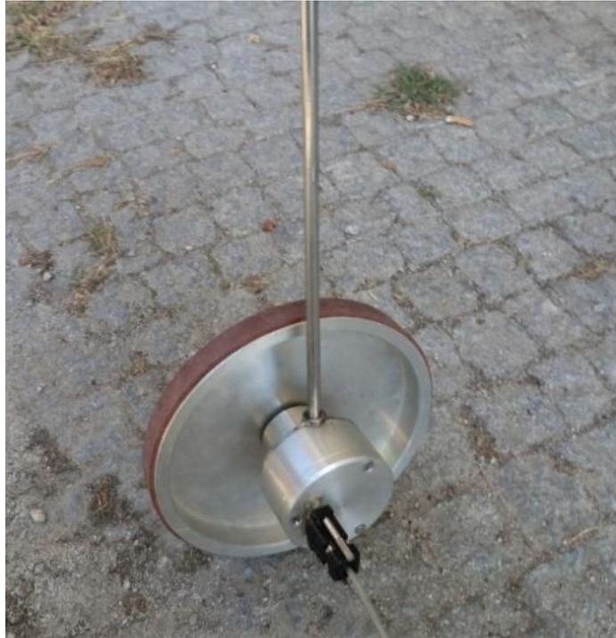
Figura 30 - Dispositivo de medição de distância horizontal
