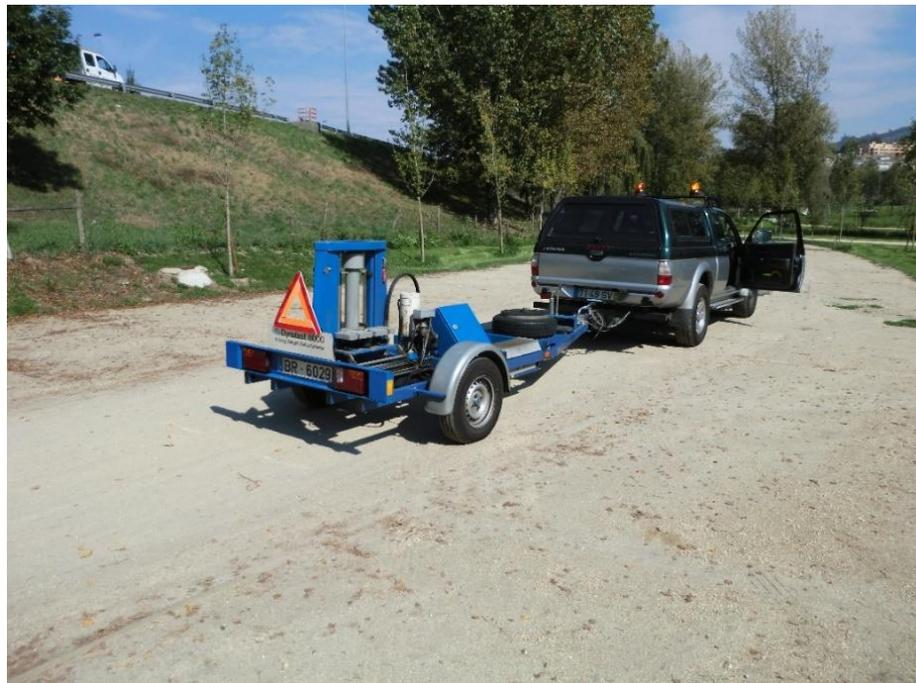
Figura 33 - Execução de medição com FWD (2ª fase)
