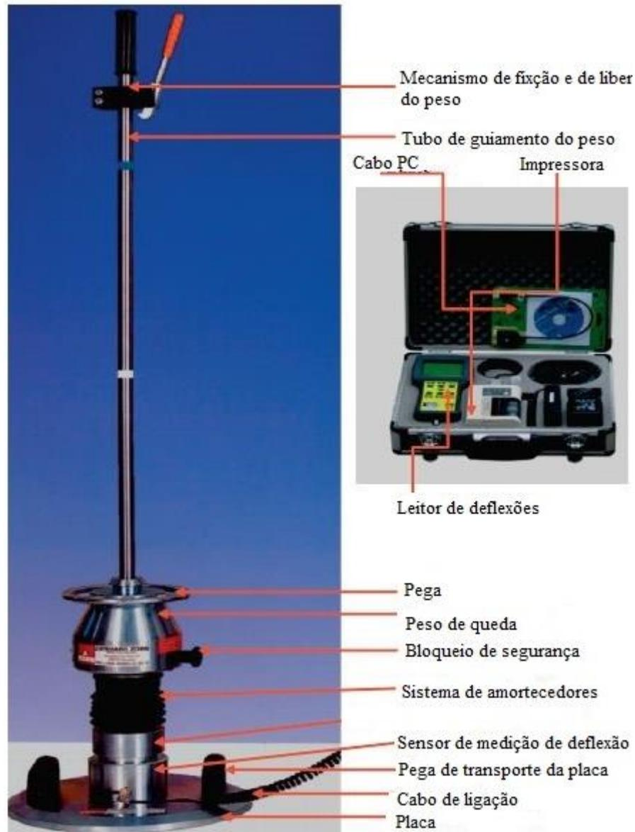
Figura 12 - Constituição de um LFWD (adaptado de Elhakim *et al.*, 2014)
