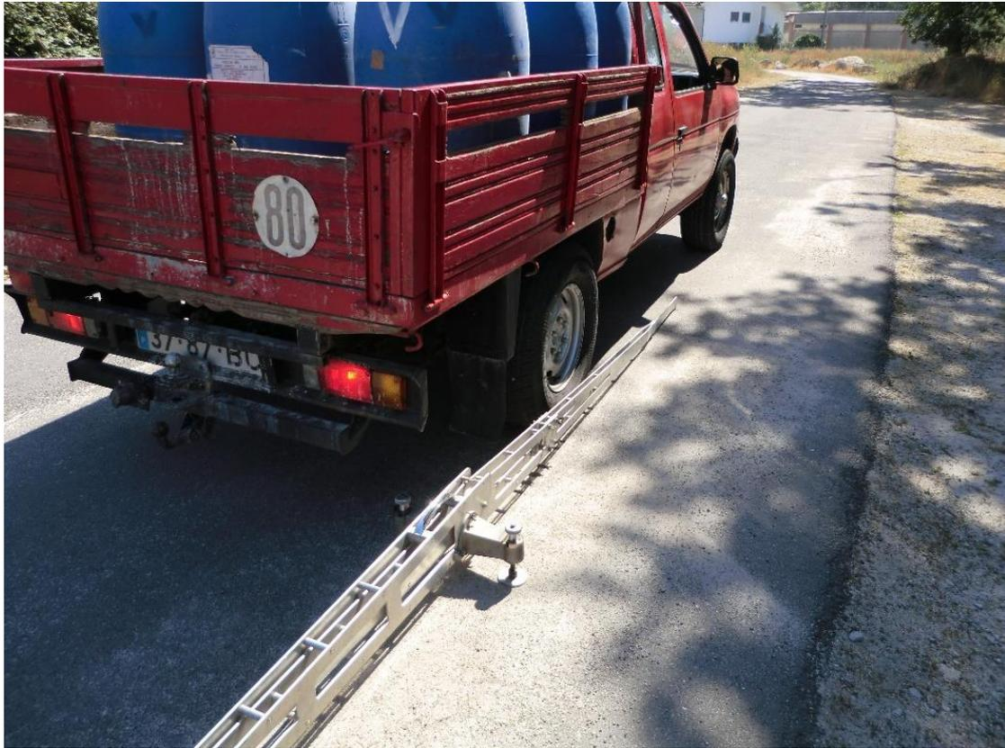
Figura 36 - Adaptação para rodado simples no ensaio da Viga Benkelman
