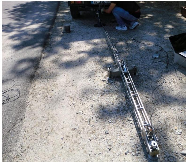
Figura 40 - Execução do ensaio de carga com placa
