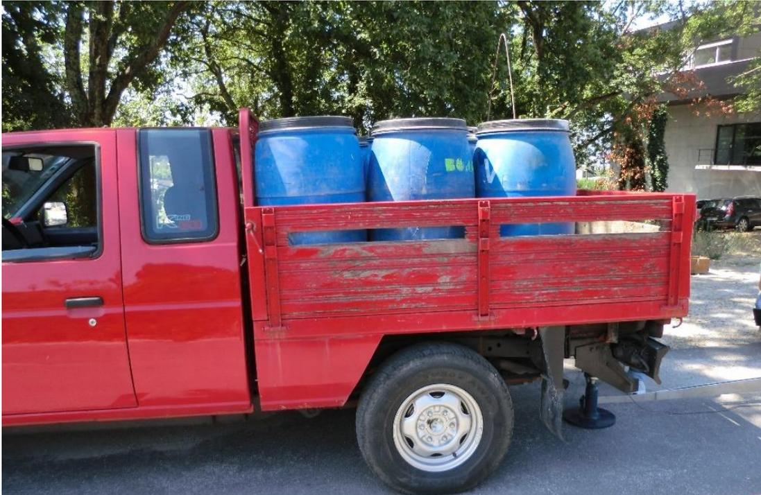
Figura 31 - Veículo utilizado durante os ensaios de carga com Viga Benkelman e com Placa
