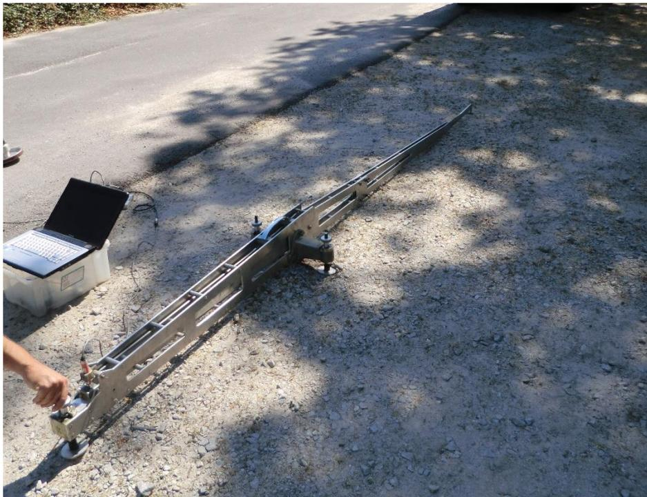
Figura 27 - Viga Benkelman utilizada
